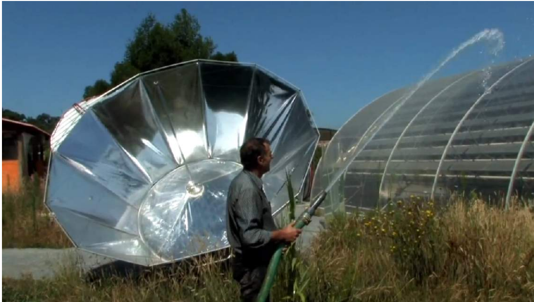
Figure 1.18 : Le moteur solaire-hydraulique Sunpulse™ peut assurer un débit d'irrigation de 400 m 3 / jour en eau de surface ou 25 m 3 / jour de pompage à 30 m de profondeur. (Sunvention)
