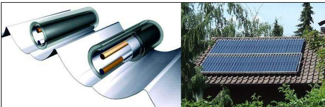
Figure 2.2 : Le capteur "Tubo 12 CPC" : L'enceinte en verre au Borosilicate est évacuée à 5 mPa, les renforteurs CPC en aluminium permettent un fonctionnement avec un débattement angulaire de l'incidence solaire de +/- 50° environ . Prévu pour des applications domestiques, le fabricant indique une température de stagnation de 250°C. L'absorbeur en cupro-nickel forme une boucle dans l'enceinte évacuée pour se raccorder à une rampe mettant en parallèle tous les tubes (type "baïonnette"). (Consolar)
