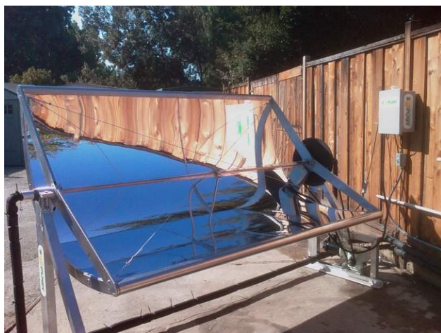
Figure 2.5 : Un petit capteur cylindro-parabolique modulaire : le SopoNova 4.0 . Destiné aux micro-systèmes décentralisés de production d'électricité, cogénération, climatisation. Ces modules de 5,57m 2 sont prévus pour fonctionner entre 90°C et 200°C sous une insolation de 850 W/m 2 . Une puissance de moyenne 0,512 kWth par module permet d'adapter le champ de captage au plus près du besoin. (Sopogy)
