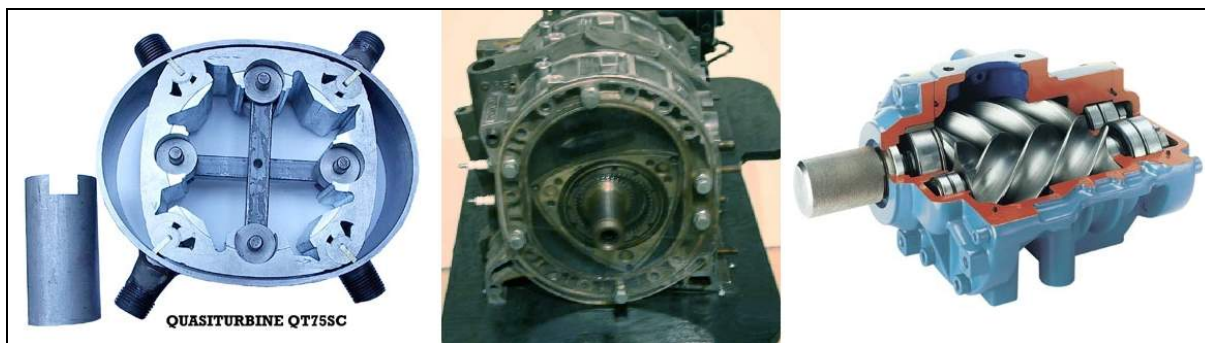
Figure 2.15 : Quelques machines volumétriques exotiques (de gauche à droite) : quasiturbine (QT Agence), moteur Wankel (Mazda), compresseur à vis : surtout pour les hautes puissances (Aerzen)
