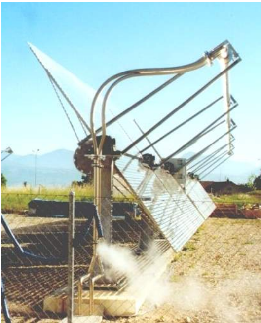
Figure 2.7 : Un concentrateur extra-plat (CEP) . On note l'orientation selon l'axe médian du concentrateur et les raccords souples de l'absorbeur. (EPFL-LENI)
