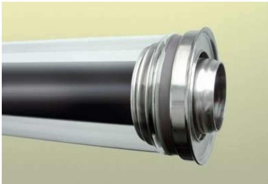
Figure 2.1 : Absorbeur PTR70 : D'apparence sobre, ce capteur moyenne température est parmi les plus évolués du marché. Le raccord spécial assure l'étanchéité et compense les effets de dilatation avec un minimum de fuites thermiques. Le revêtement multi-couches du tube interne confère une absorbtivité d'environ 95% pour une émissivité de seulement 14% entre 350°C et 400°C. (Schott)
