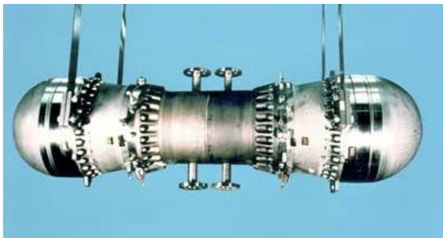
Figure 2.18 : Générateur expérimental composé de deux modules MSPL / générateur en opposition : Prévu pour des applications spatiales, dimensionné pour une puissance continue de 2 \times 12,5 \text{kWe} . L'alimentation thermique moyenne température (solaire ou nucléaire) se fait dans la partie centrale par un sel fondu ; deux générateurs linéaires sont logés dans les extrémités de l'appareil, le tout étant hermétique. Un module testé sous 75 bars d'hélium (mi-puissance) produit 6,5kWe avec des sources chaude à 630K, un puits froid à 315K et un rendement global de 20% . (NASA / MTI, 1986)
