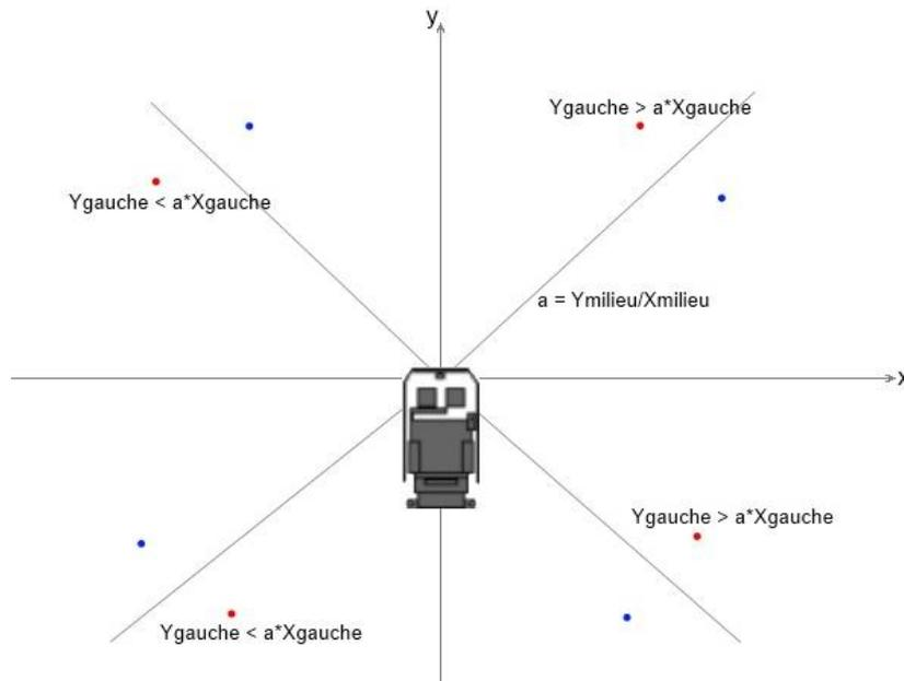
Fig. 3.14 : Méthode pour déterminer le sens de franchissement d'un passage étroit.
