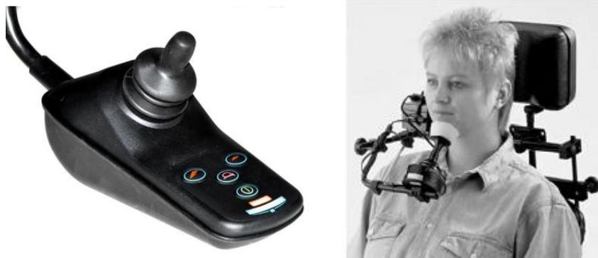
Fig. 1.13 : Joystick standard (a), Joystick au menton (b).
