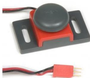
Fig. 1.4 : Capteur de contact, type « Bumper ».
