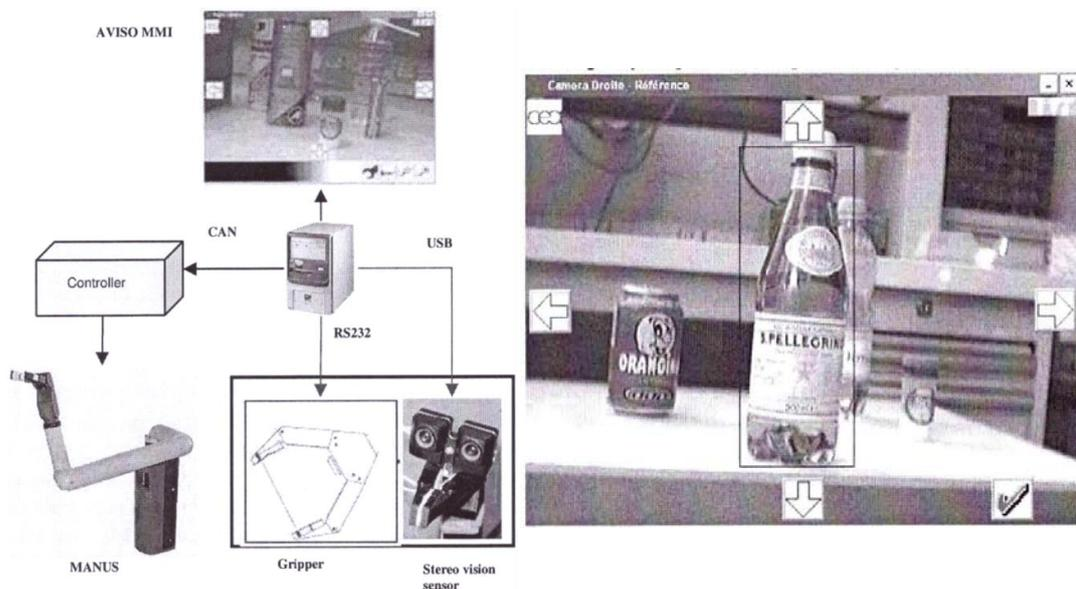
Fig. 1.34 : Système AVISO, (Leroux et al. 2007).
