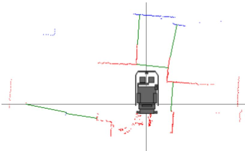
Fig. 3.11 : Recherche de passages étroits dans un environnement complexe avec validation.
