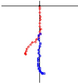
Fig. 2.32 : Trajectoire obtenue avec  $K_i=0$ ,  $K_p=4$  et  $K_d=11$  (Angle de départ de  $40^\circ$ ).
