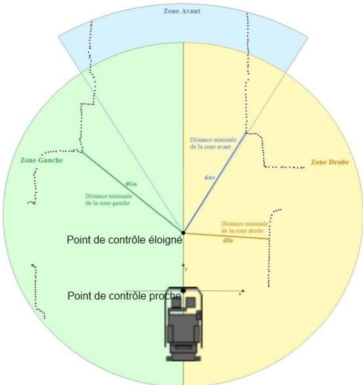
Fig. 3.25 : Ajout des points de contrôle.
