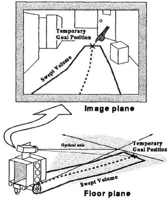
Fig. 1.28 : Principe de fonctionnement de l'interface proposée dans (Sekimoto, Tsubouchi, et Yuta 1997).
