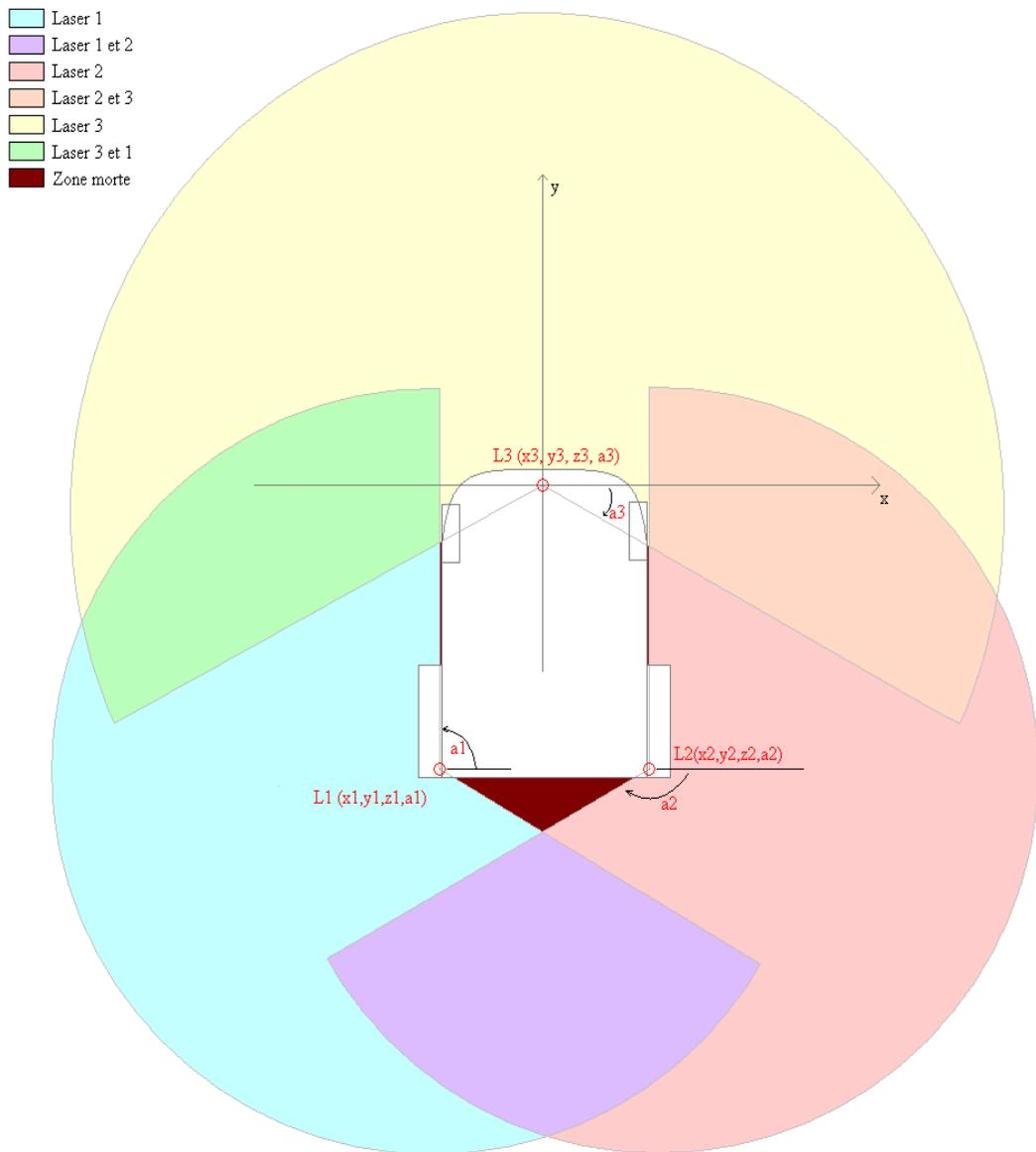
Fig. 2.17 : Chevauchement des visions des capteurs lasers.
