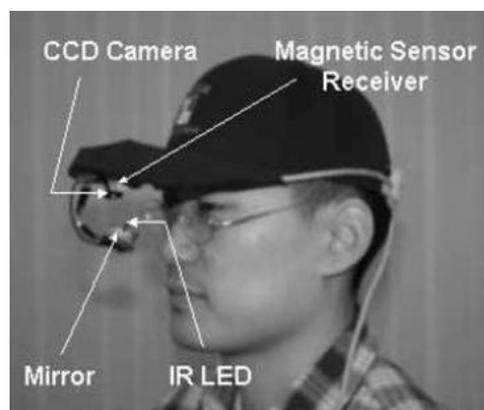
Fig. 1.36 : Casquette permettant d'analyser le regard de l'utilisateur.
