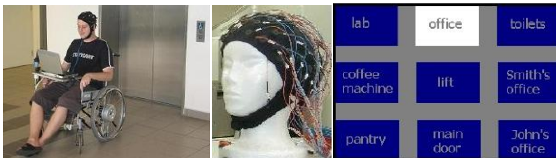
Fig. 1.20 : Prototype BCW (a), avec son capteur BCI (b), et son interface (c).
