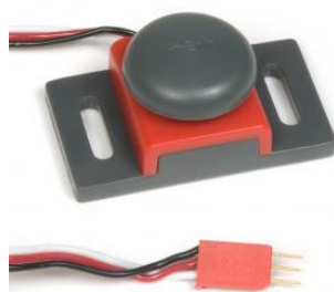
Fig. 1.4 : Capteur de contact, type « Bumper ».
