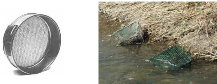
Figure II-2. Matériels utilisés pour l'échantillonnage de G. roeseli : tamis de 500 \mu\text{m} de vide maille (gauche) et pièges artificiels (droite)
