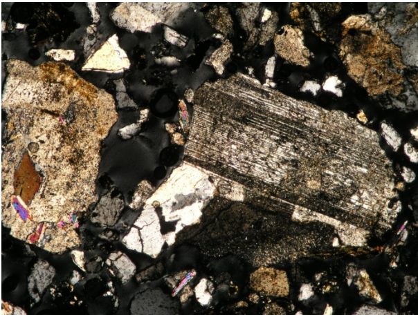
Fig. 25 : Aspect du sable prélevé à Soultzbach, dans le vallon du Grossthal, plagioclase altéré
