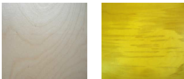
Figure 80: Aspect général de l'échantillon avant (à gauche) et après vieillissement (à droite) Gardner
