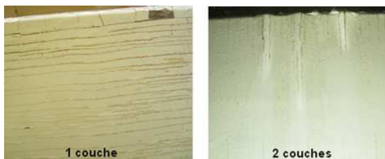
Figure 79: Aspect général des 2 échantillons 640UV blanc après 3 semaines – vieillissement Gardner
