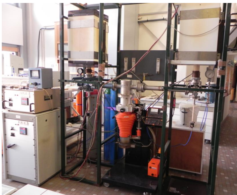
Figure 20: Photographie du four vertical sous atmosphère contrôlée.
