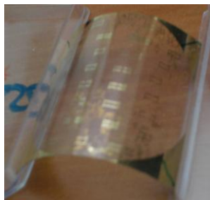
Transducteurs interdigités sur les polymères flexibles
