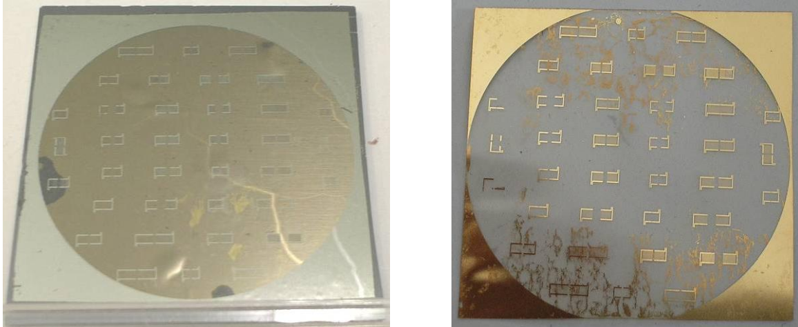
Figure 3.4-4: Etat du dépôt des métaux au verso des films autosupportés après la mise en œuvre des dispositifs: à gauche un film épais encore plaqué sur son support (métallisation Cr+Al) avec un enrobage complet, à droite un film seul (métallisation Cr+Au) avec un enrobage incomplet.
