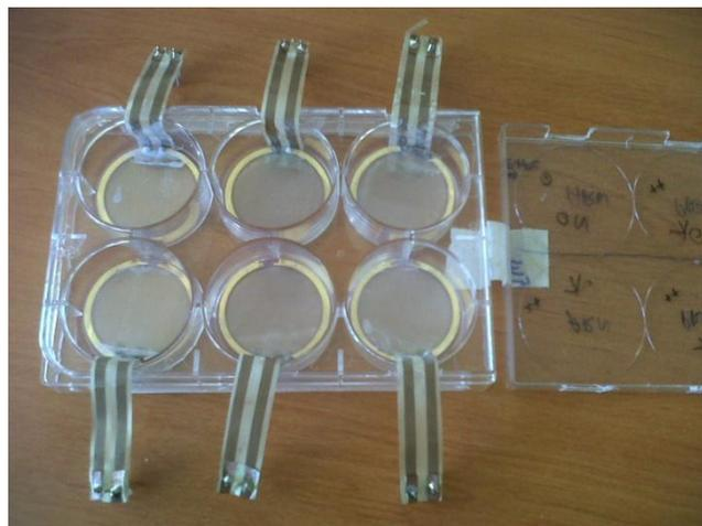
*Systèmes sur P(VDF-TrFE)/ZnO 5 wt.% pour exciter des cellules souches dans des puits de culture*
