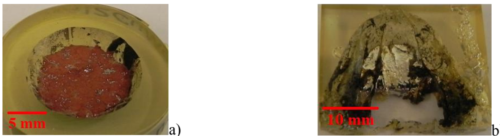
Figure 158 : Micrographies optique de surface des phases Al_2CuMg (a) et MgZn_2 (b) après 20 heures d'immersion dans la solution Socosurf
