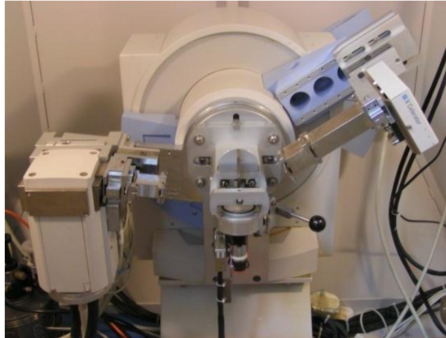
Figure 19 : Diffractomètre X'Pert Pro (montage en réflexion)
