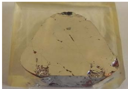
Figure 74 : Phase Al 2 Cu après immersion 3 semaines dans H 2 SO 4 200 g/l
