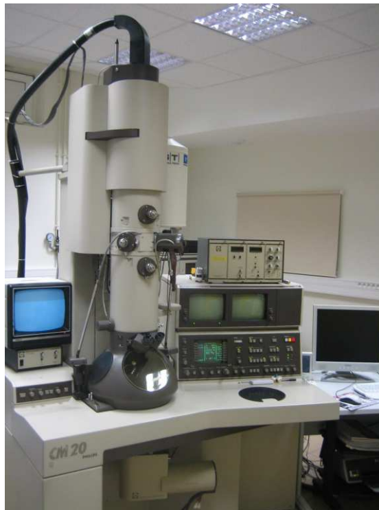
Figure 7 : Détermination des changements morphologiques par TEM
