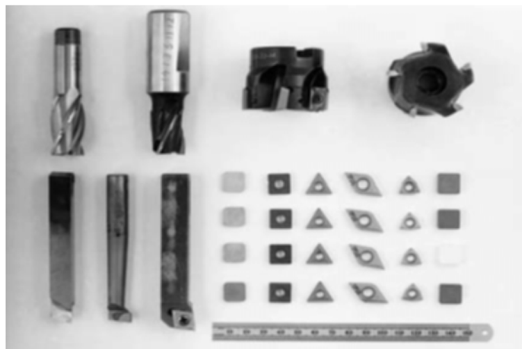
Figure 1. 2 : Exemples d'outils de coupe utilisés dans les différents procédés de la Figure 1. 1, [Chi02].
