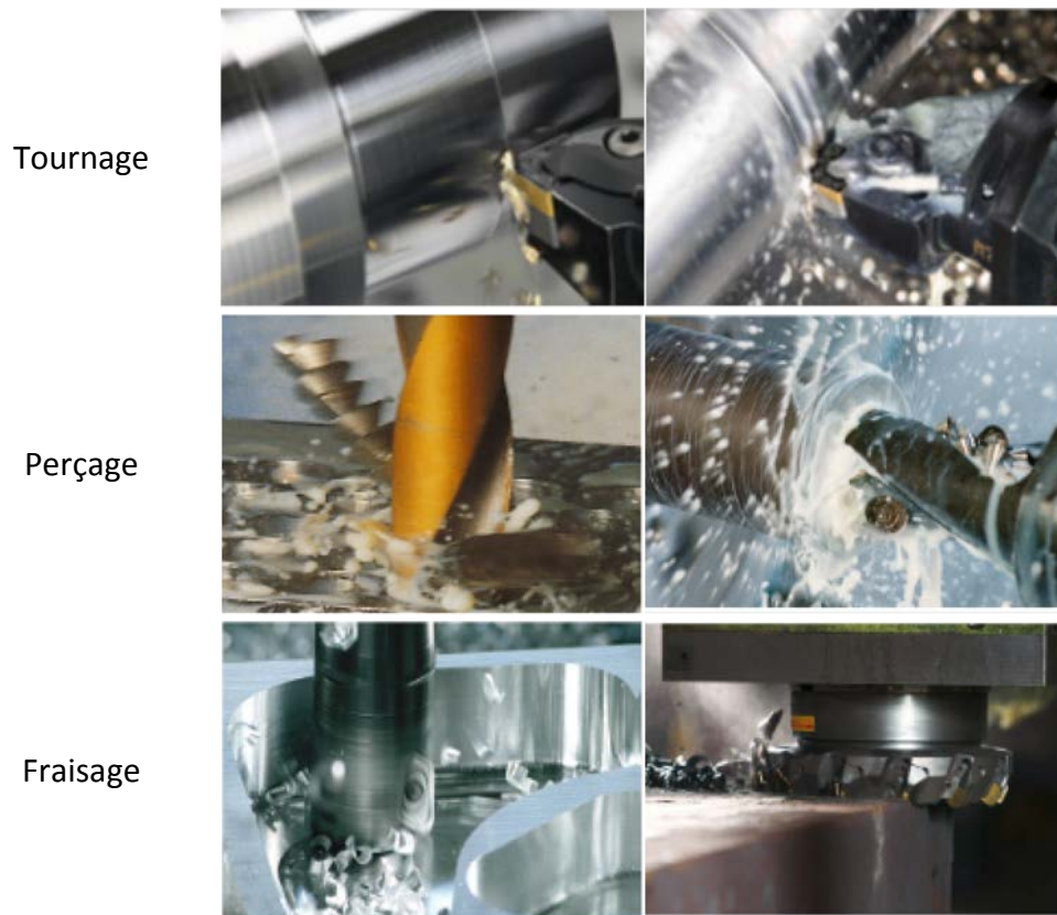
Figure 1. 1: Exemples des procédés d'usinage par enlèvement de matière, [San].
