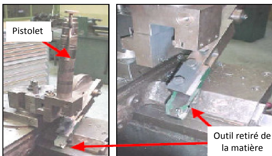
Figure 1. 9 : Dispositif de coupe brusquement interrompue « Quick- Stop » monté sur un tour CN. Manipulation réalisée par Poulachon et al. [Pou99]. Le système d'interruption est déclenché par un tir de pistolet.
