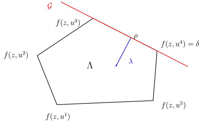
FIGURE 2.3 – Hyperplan d'appui  $\mathcal{G}$  sur le polyèdre  $\Lambda$ .
