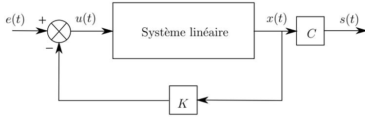
FIGURE 2.19 – Commande par retour d'état d'un système linéaire
