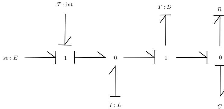
FIGURE 1.4 – Modélisation du buck-boost sous bond graph
