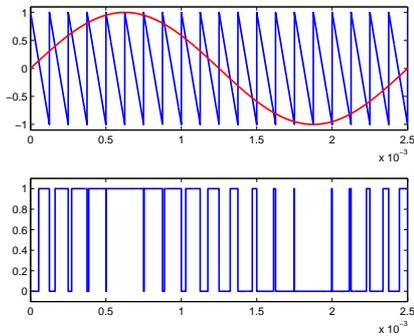
FIGURE 3.2 – Exemple d'une PWM intersective analogique
