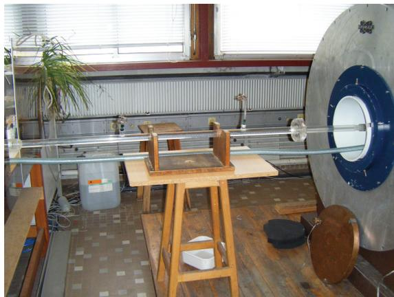
FIGURE 2.21 – Photo de la veine de mesure du dispositif expérimental (RMN)
