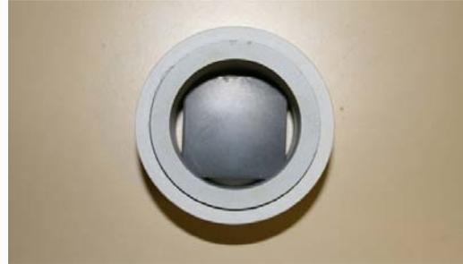
**Figure 5.4** – Échantillon dans son support en Stumatite
