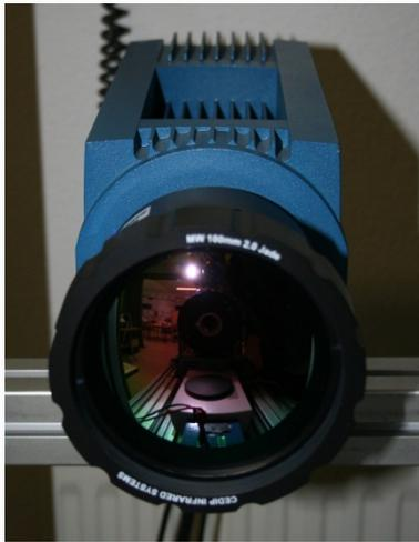
**Figure 5.6** – Caméra Infrarouge Cedip® Jade III
