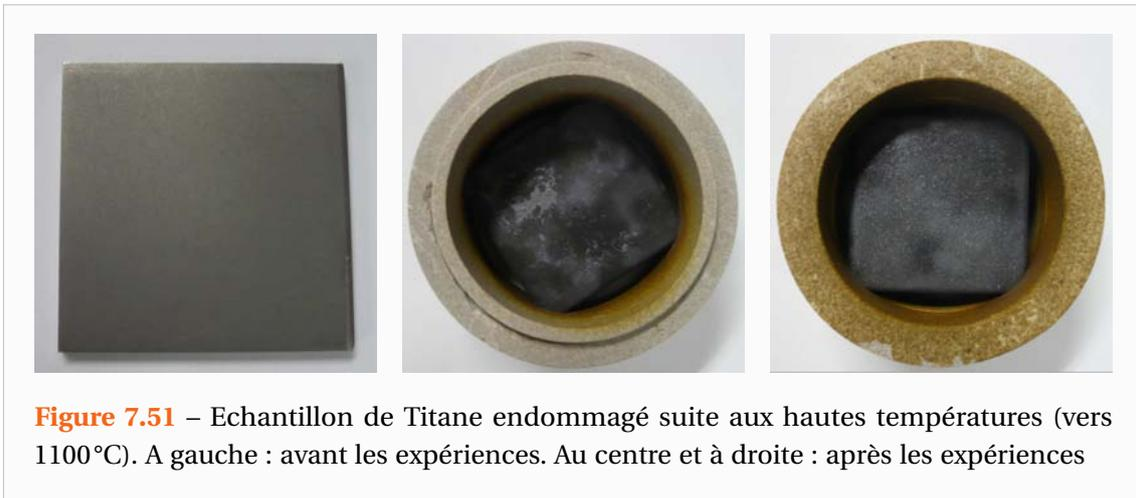
Figure 7.51 – Echantillon de Titane endommagé suite aux hautes températures (vers 1100°C). A gauche : avant les expériences. Au centre et à droite : après les expériences
