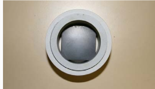
Figure 5.4 – Échantillon dans son support en Stumatite
