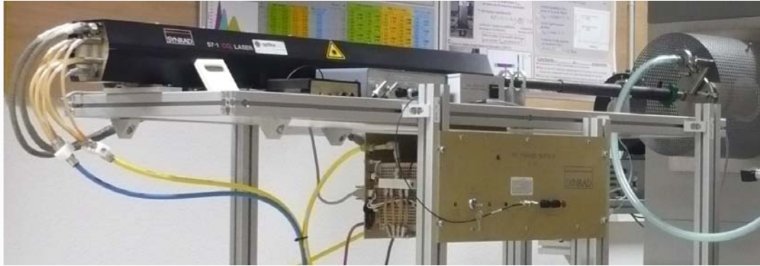
Figure 5.23 – Laser CO 2 continu 130W et instruments de contrôle
