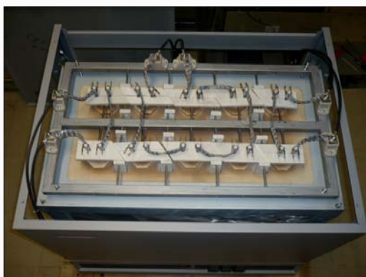
Figure 5.15 – Alimentation des éléments chauffants du Four Tubulaire
