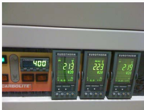
Figure 5.17 – Régulateurs indépendants pour les trois zones de chauffe
