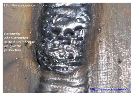
Figure 18 : Porosités débouchantes en surface de cordon de soudure
