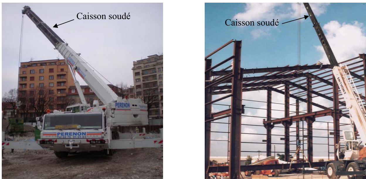
Figure 37 : Utilisation des caissons soudés dans les grues
