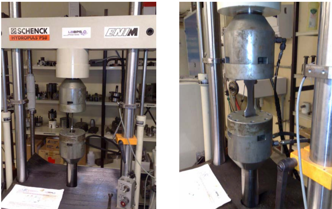
Figure 62 : Essai de fatigue en traction uni-axial.
