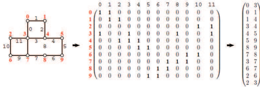
FIGURE 4.13: Graphe et matrice adjacente : (a) graphe, (b) matrice d'incidence, (c) vecteur (nœuds terminaux)
