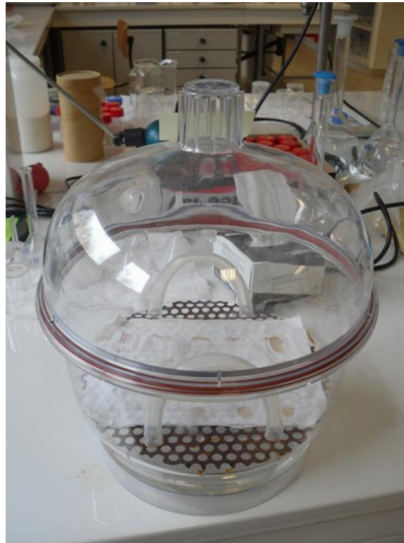
Figure II-10: Dispositif expérimental pour la prise en eau(photo : Mbey)
