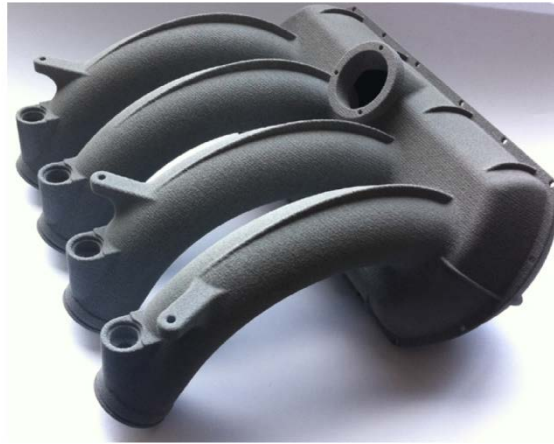
Figure II. 12 : Tubulures d'admission fabriqué directement par SLS à partir d'un mélange PA / AlCuFeB (Adaptée de [Ken 2012]).
