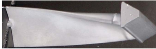
Figure II. 14 : Pale de turbine d'une longueur de 8 cm couverte d'une fine couche de 0,3 mm d'AlCoFeCr fabriquée pour l'ONERA (Adaptée de [Dub 2012]).
