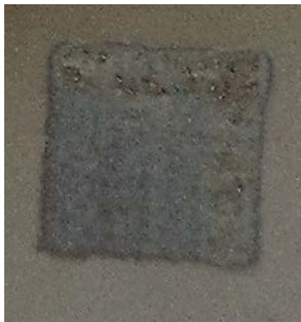
Figure III. 14 : Une monocouche de 1 cm 2 réalisée par stéréolithographie à partir de la poudre AlCuFeB tamisée à 25 µm et préchauffé à 620°C.
