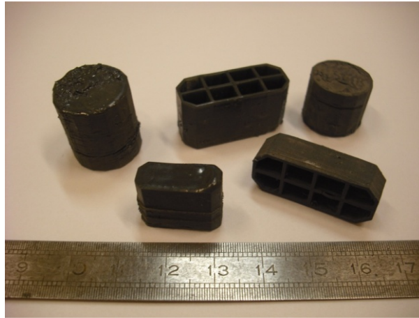
Figure V. 11 : Pièces réalisées par stéréolithographie à partir d'un mélange résine Si40 renforcée par 20 % vol. des poudres quasicristallines AlCuFeB.
