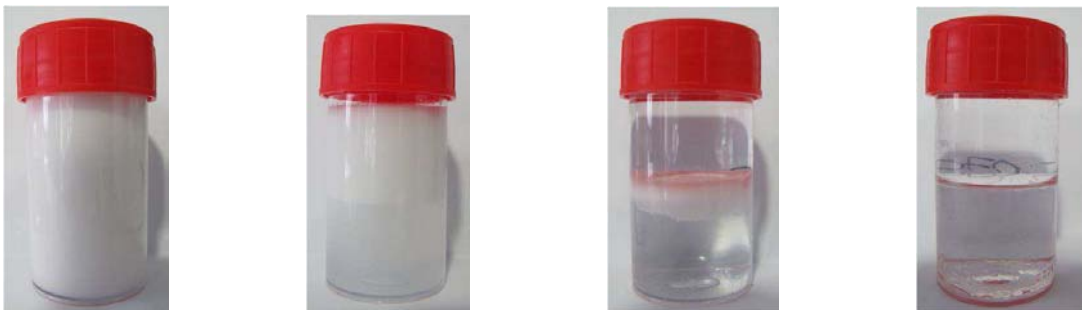
(a) Émulsion (b) Émulsion crémée (c) Émulsion coalescée (d) Émulsion cassée
