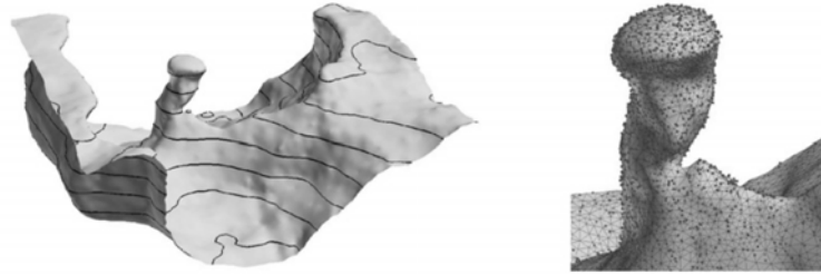
FIGURE 1.3 – a. Dôme de sel construit par méthode implicite. b. Détail du dôme avec les points de données visibles. D'après Frank et al. [2007].
