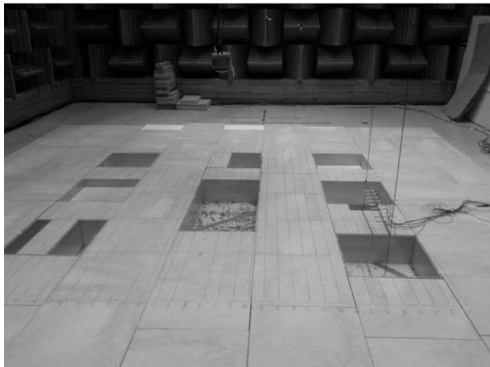
FIGURE 3.13 – Géométrie du réseau aperiodique formé par 9 cavités de tailles et d'espacements différents.
