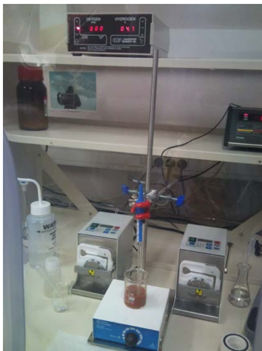
Figure I.2. Système de synthèse utilisant les pompes péristaltiques installé dans une chambre anaérobie.
