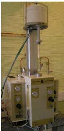
Figure I.14. Photographie de la thermobalance SETARAM TG/ATD 92-16.18 .
