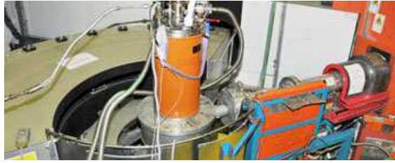
Figure I.22 : Photographie du diffractomètre D1B à l'ILL.
