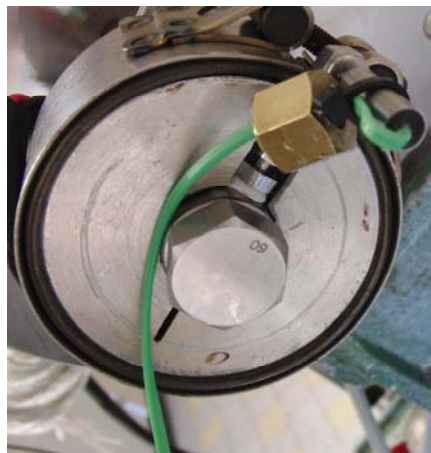
Fig.: 19 – Assemblage de la buse 60 \mu\text{m} avec l'élément chauffant.
