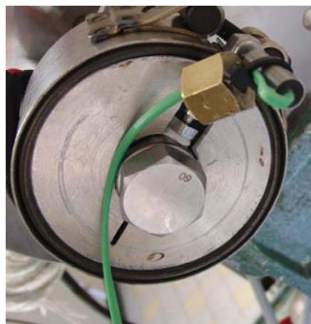
**Fig.: 19** – Assemblage de la buse 60 µm avec l'élément chauffant.
