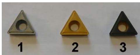
Figure 3.6 : Plaquettes de coupe utilisées pour les essais de tournage : 1 – THM (sans revêtement), 2 - TN7110 (TiN-TiCN-Al 2 O 3 -TiN), 3 - TN5120 (TiN-TiCN-Al 2 O 3 )
