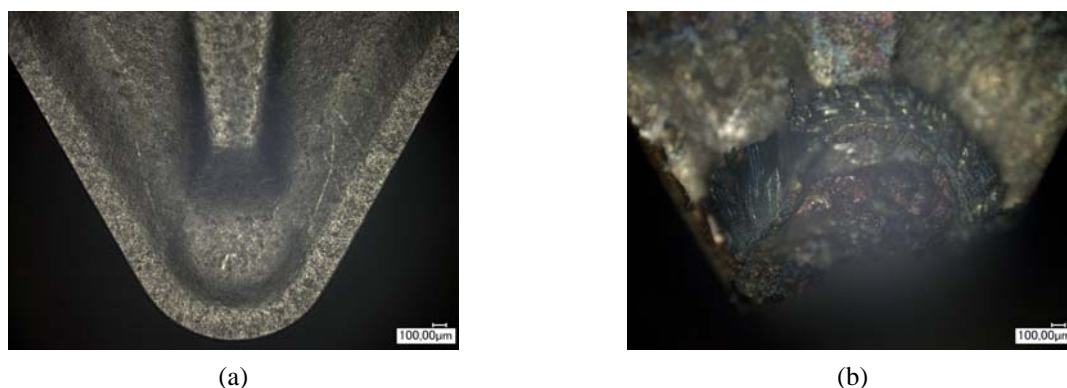
Figure 3.25 : Outil de coupe non revêtu en carbure (a) neuf, (b) usé ayant servi lors de l'usinage à sec de l'acier inoxydable AISI 304L avec les conditions de coupe suivantes : V_c = 300 m/min; f = 0.2 mm/tr et a_p = 1 mm
