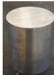
Figure 3.2 : Bloc usiné en acier inoxydable AISI 304L (Diamètre 100 mm ; longueur 120 mm)
