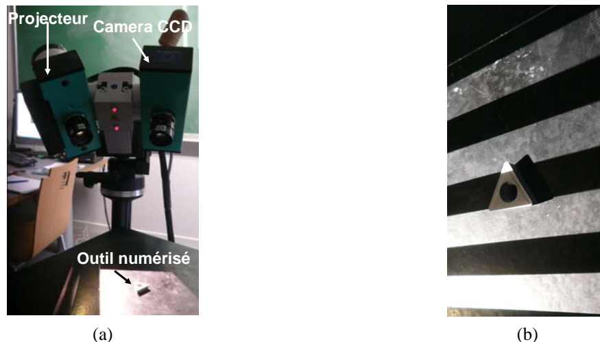
Figure 4.3 : Outil de coupe TCMT16T308 en cours de numérisation : (a) dispositif ; (b) franges de lumière projetée sur l'outil de coupe
