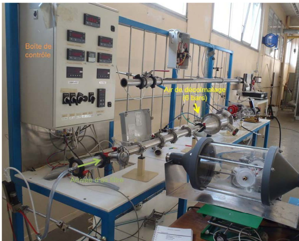
Figure 5.16 : Vue d'ensemble du banc "décolmatage".
