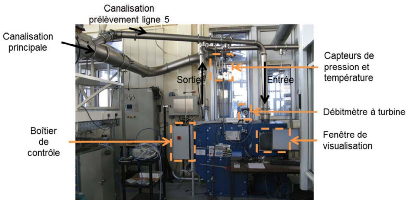
Figure 5.6 : Vue générale du dépoussiéreur pilote
