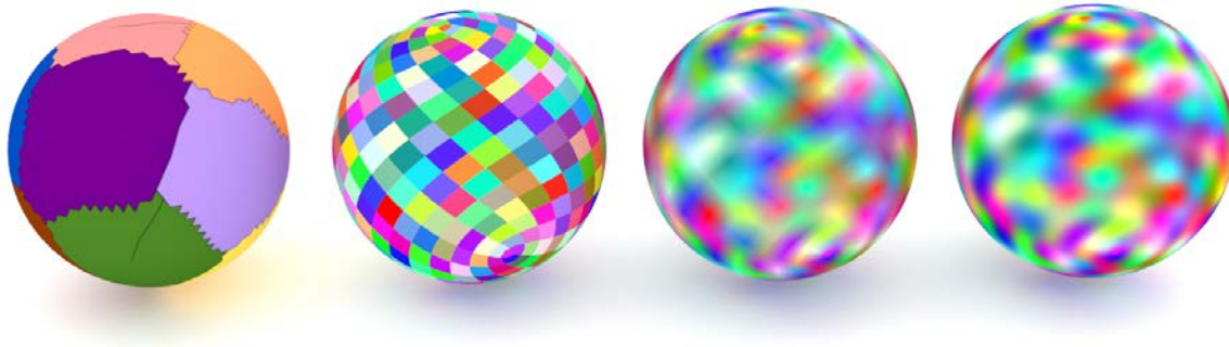
FIGURE 2.16 – Placage sans couture visible pour différents modes de filtrages. De gauche à droite, les différentes cartes et les filtrages au plus proche bilinéaire et bicubique. Ici, la paramétrisation contient quatre singularités d'indice \frac{2}{2} visibles en haut et en bas de la sphère, en particulier sur le filtrage au plus proche. Aucune couture n'est apparente, même autour des singularités.
