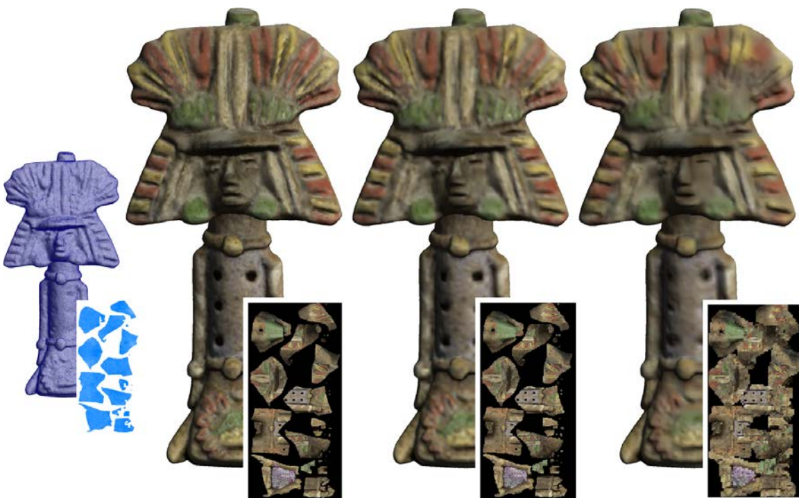
FIGURE 2.29 – Trois niveaux de Mipmaps, du plus fin à gauche au plus grossier à droite. L'atlas reste le même pour les trois niveaux, mais la résolution de la texture change.
