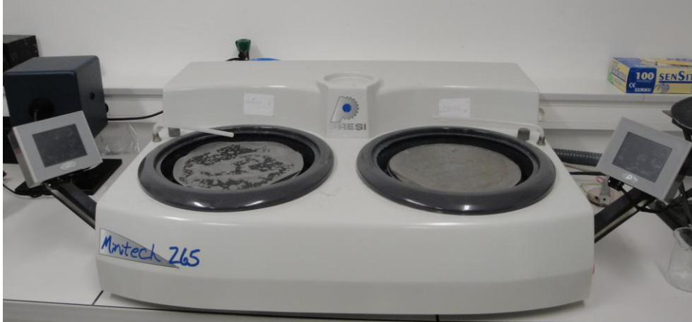
figure II.10 : Dispositif de polissage utilisé afin d'obtenir un état de surface lisse (Presi Minitex 265).
