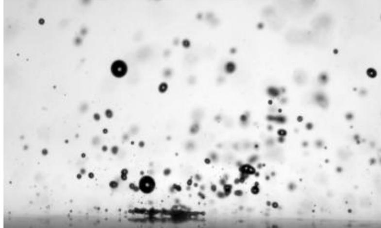
figure I.3 : Images obtenues par ombroscopie rapide de différents types d'impact sur une paroi chaude.  $f_{inj}$  est la fréquence d'injection des gouttes. ( a ) :  $D_0 = 120 \mu m$ ,  $f_{inj} = 16\,400 \text{ Hz}$ ,  $We_n = 19,93$ , b ) :  $D_0 = 138 \mu m$ ,  $f_{inj} = 11\,000 \text{ Hz}$ ,  $We_n = 49,87$ , c ) :  $D_0 = 138 \mu m$ ,  $f_{inj} = 11\,000 \text{ Hz}$ ,  $We_n = 154,78$  )
