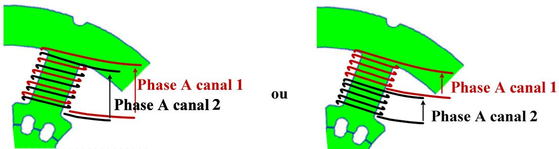
Figure II-31 configurations deux bobines par plot.
