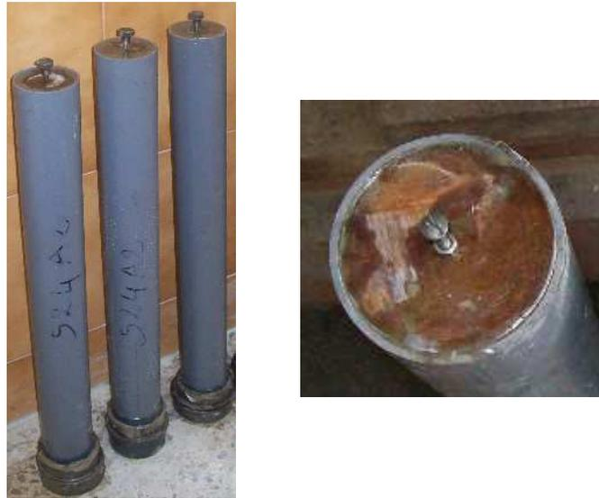
Fig. 5.21 : Eprouvettes après coulage
