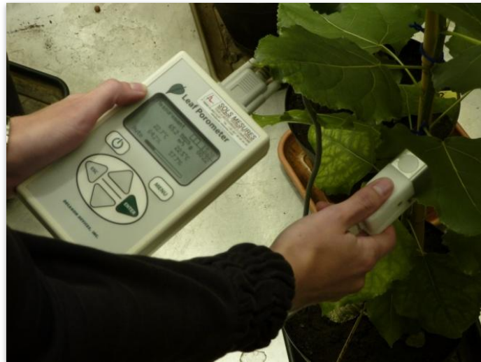
Figure 35 : Mesure de la conductance stomatique sur la face adaxiale de la feuille réalisée à l'aide du poromètre SC1
