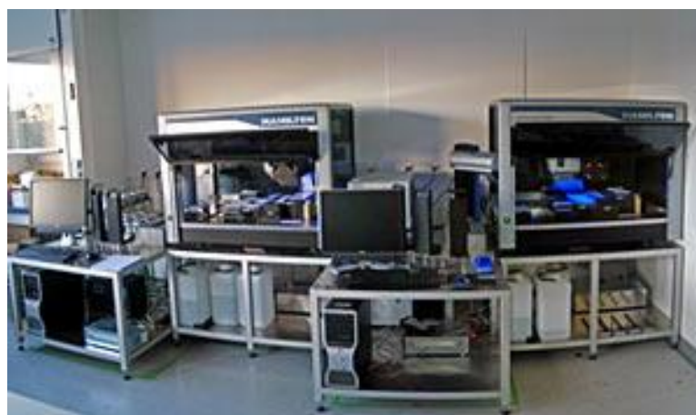
Figure 43 : Plateau robotisé de phénotypage enzymatique à haut débit
