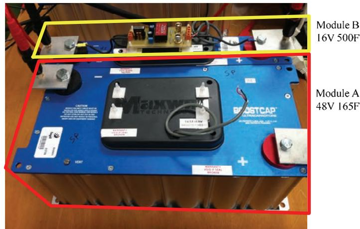
Figure 3-33. Banc de supercapacités utilisé en moyenne tension.
