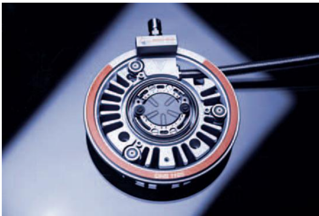
Figure II- 14: Chambre de recuit utilisée pour la diffraction des rayons X de type Anton Paar DHSC 1100
