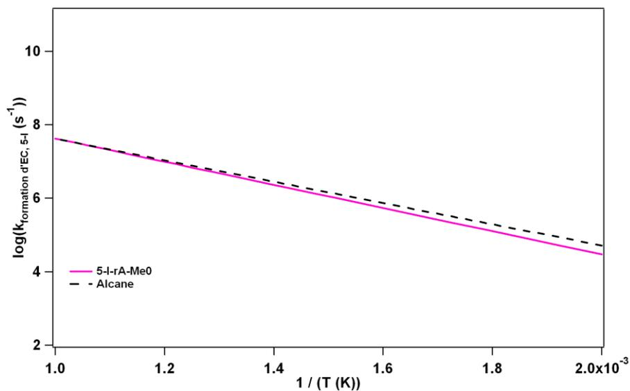
Figure III-40 : Evolution en fonction de la température des constantes de vitesse issues de la nouvelle corrélation des réactions de formation d'éthers cycliques de type 5-I.
