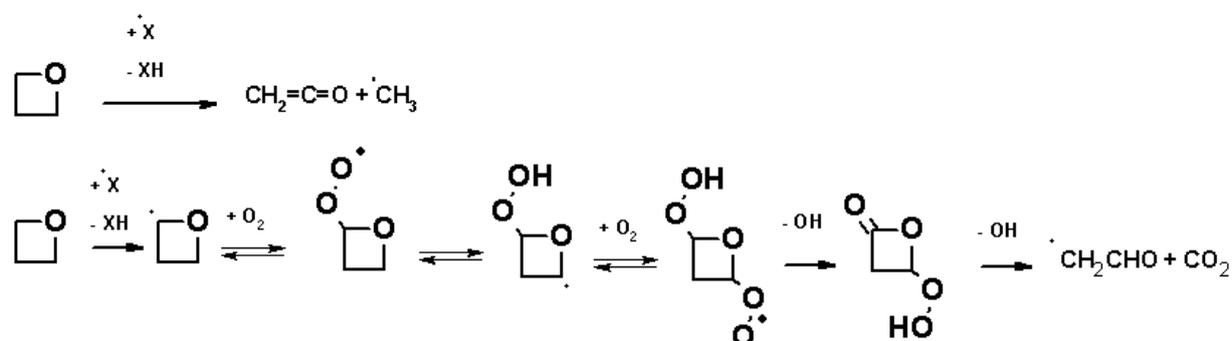
Figure III-45 : Décomposition de l'oxétane dans les mécanismes générés par le logiciel EXGAS.
