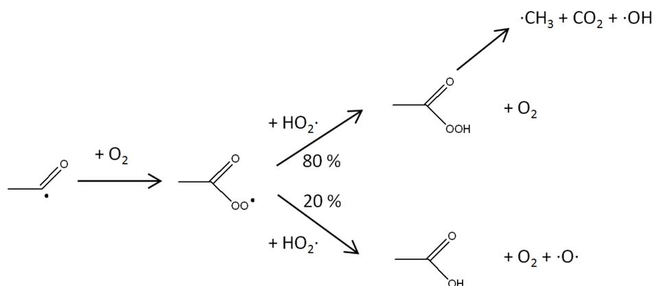
Figure IV-7 : Mécanisme de production d'acide acétique.
