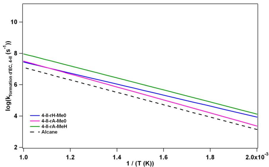
Figure III-39 : Evolution en fonction de la température des constantes de vitesse issues de la nouvelle corrélation des réactions de formation d'éthers cycliques de type 4-II.
