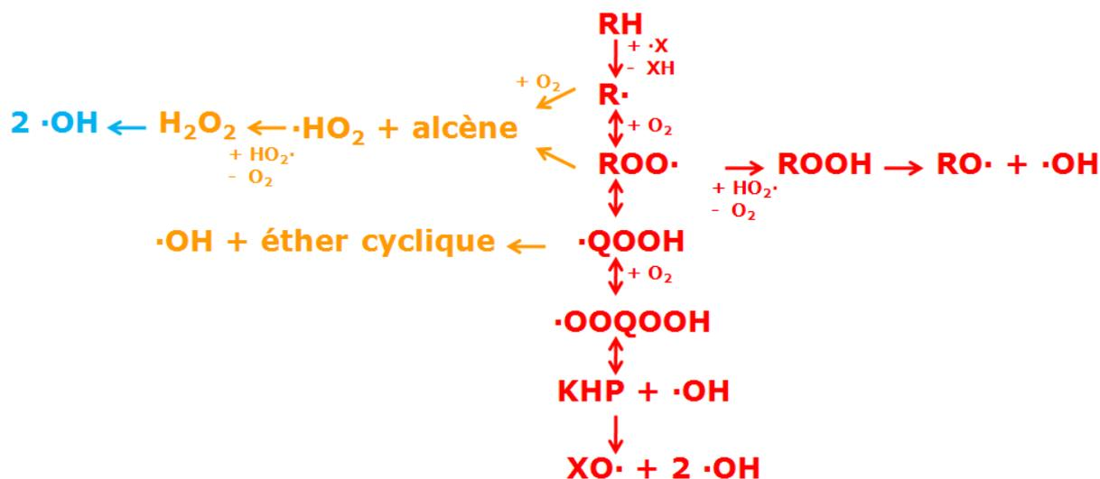
Figure I-4 : Représentation schématique du mécanisme de combustion des alcanes à basse température [Battin-Leclerc (2008)].
