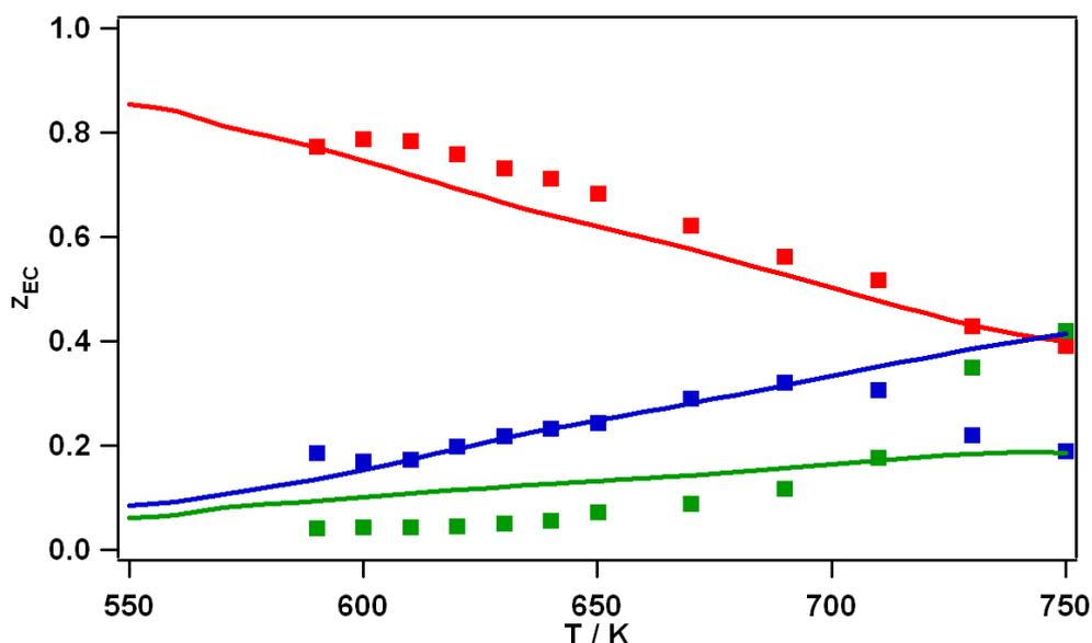
Figure IV-14 : Sélectivité des éthers cycliques à 4 atomes de carbone (rapport entre la fraction molaire d'un type d'éther cyclique avec la somme des fractions molaires des éthers cycliques à 4 atomes de carbone) en fonction de la température (points = expérience réalisée à Nancy, traits = simulation avec le mécanisme de type 3 ; rouge = oxirane, bleu = oxétane, vert = oxolane).
