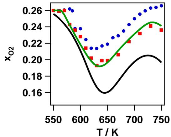
Tableau A4-6 : Profils expérimentaux (carrés = expériences réalisées à Nancy, ronds = expériences réalisées à Hefei) ou simulés (trait noir = mécanisme de type 1<sup>21</sup>, trait vert = mécanisme de type 3) du *n*-butane et de l'oxygène pour la combustion du *n*-butane à basse température.
