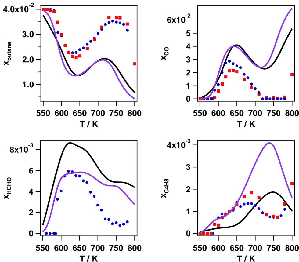
Figure I-11 : Résultats expérimentaux (carrés = expérience réalisée à Nancy, ronds = expérience réalisée à Hefei) et de simulation (noir = mécanisme issu du logiciel EXGAS, violet = mécanisme de Healy et al. (2010)) pour la combustion du *n*-butane à basse température (espèces de fraction molaire maximale supérieure à  $10^{-3}$ ).
