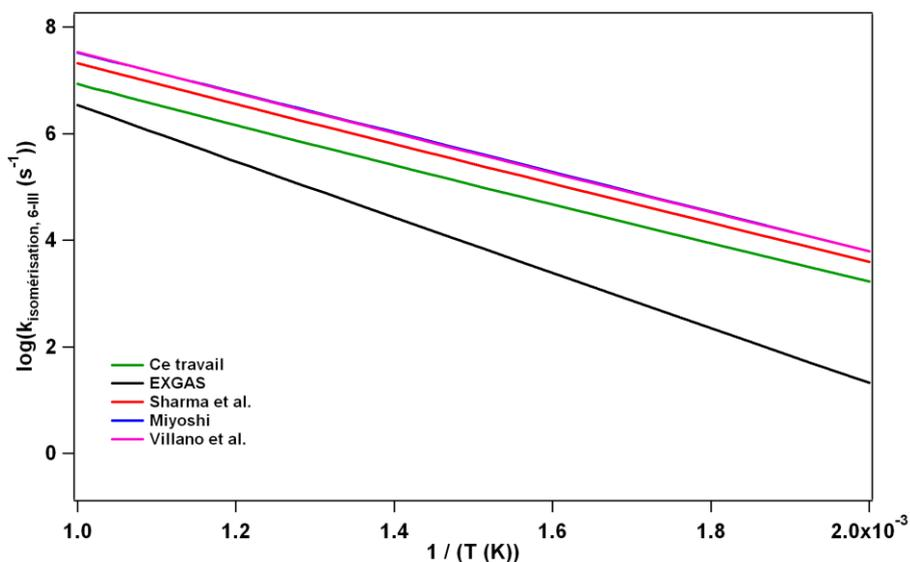
Figure III-9 : Comparaison pour la réaction d'isomérisation de radicaux  $ROO\bullet$  faisant intervenir un état de transition avec une partie cyclique à 6 atomes et un atome d'hydrogène transféré tertiaire des constantes de vitesse calculées dans le cadre de ce travail, estimée par le logiciel EXGAS ou calculées par Sharma et al. (2010), Miyoshi (2011) et Villano et al. (2011).
