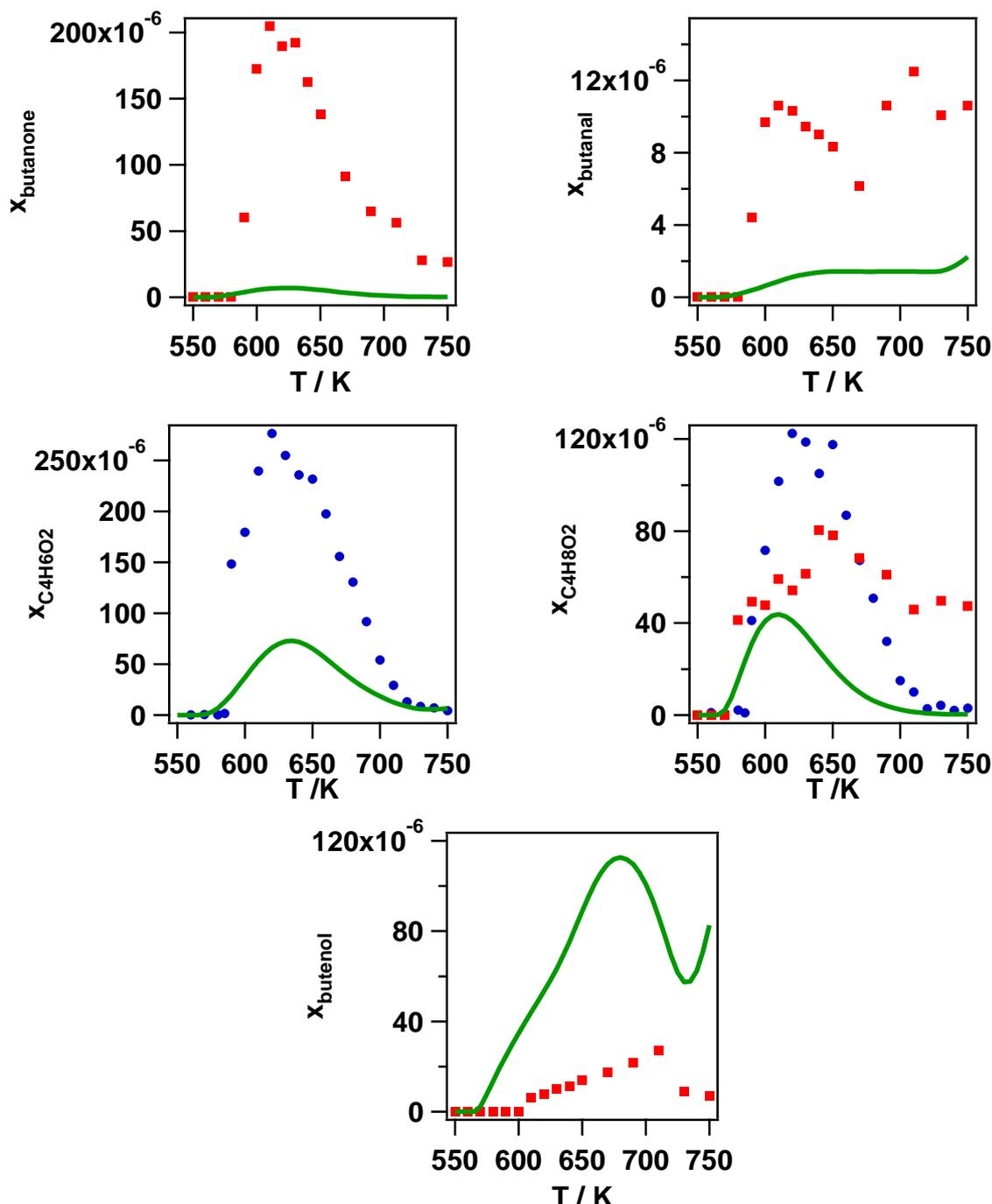
Figure IV-29 : Produits non-primaires du *n*-butane contenant quatre atomes de carbone et comprenant au moins une fonction oxygénée (carrés = expériences réalisées à Nancy, ronds = expériences réalisées à Hefei, trait = simulation basée sur le mécanisme de type 3).
