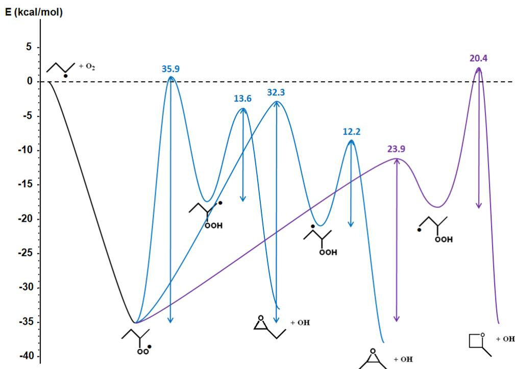
Figure III-5 : Diagramme d'énergie à 0 K des réactions d'isomérisation de radicaux ROO• et de formation d'éthers cycliques associées au système 2-C<sub>4</sub>H<sub>9</sub> + O<sub>2</sub>. Courbes bleues = isomérisation impliquant un état de transition comportant une partie cyclique à 5 atomes puis formation d'oxirane ; Courbe violette = isomérisation impliquant un état de transition comportant une partie cyclique à 6 atomes puis formation d'oxétane.
