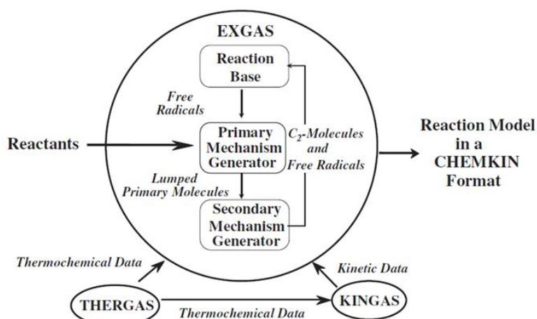
Figure I-6 : Représentation schématique du logiciel EXGAS.
