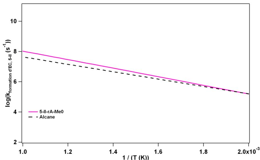
Figure III-41 : Evolution en fonction de la température des constantes de vitesse issues de la nouvelle corrélation des réactions de formation d'éthers cycliques de type 5-II.
