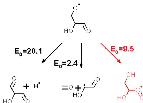
Figure III-59 : Réactions de β-scissions du radical hydroxyaldoalkoxy principal provenant de l'oxydation du propène. Les énergies d'activation à 0 K sont données en kcal/mol.
