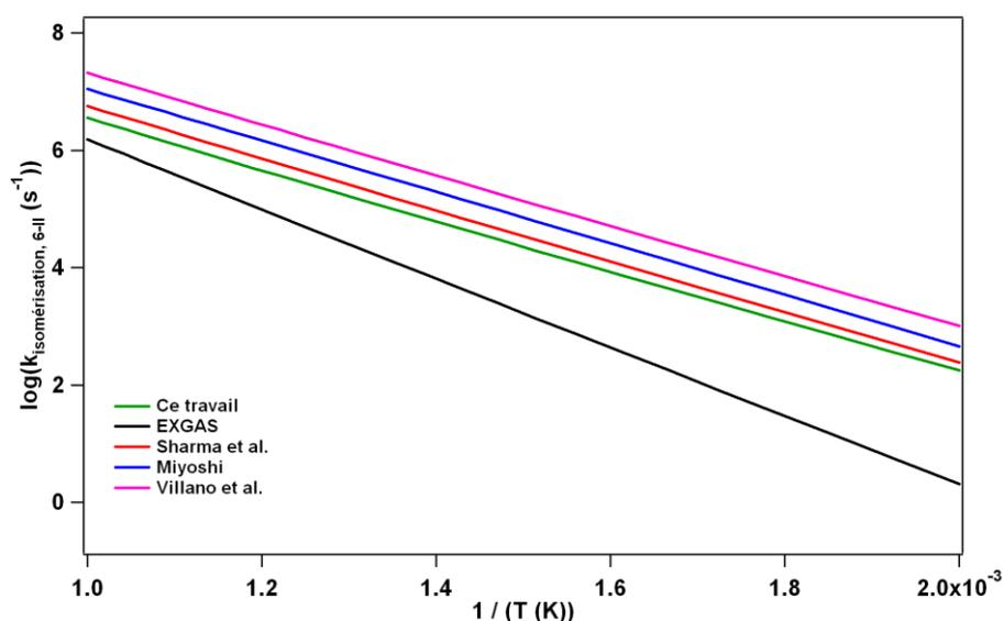
Figure III-8 : Comparaison pour la réaction d'isomérisation de radicaux  $ROO\bullet$  faisant intervenir un état de transition avec une partie cyclique à 6 atomes et un atome d'hydrogène transféré secondaire des constantes de vitesse calculées dans le cadre de ce travail, estimée par le logiciel EXGAS ou calculées par Sharma et al. (2010), Miyoshi (2011) et Villano et al. (2011).
