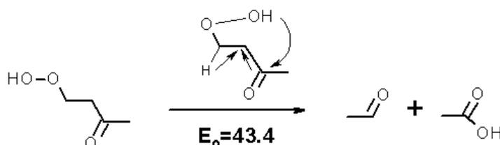
Figure III-63: Réactions de transfert du groupe hydroxyle au pied de l'atome de carbone portant la fonction carboxyle du ketohydroperoxyde principal impliqué dans le mécanisme de combustion du *n*-butane à basse température. Les énergies d'activation à 0 K sont données en kcal/mol.
