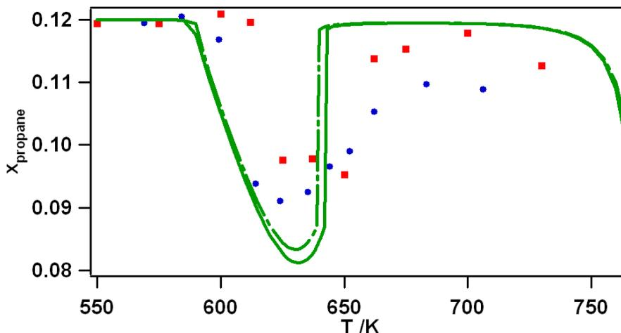
Figure IV-9 : Réactivité pour la combustion du propane à basse température (trait continu = mécanisme de type 2, trait mixte = mécanisme de type 3).
