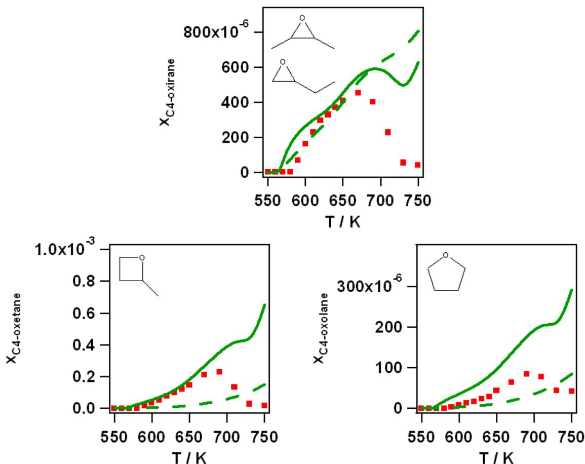
Figure IV-13 : Profils en éthers cycliques à quatre atomes de carbone dans le cas de la combustion du *n*-butane à basse température (trait continu = mécanisme de type 3 ; pointillés = mécanisme de type 2).
