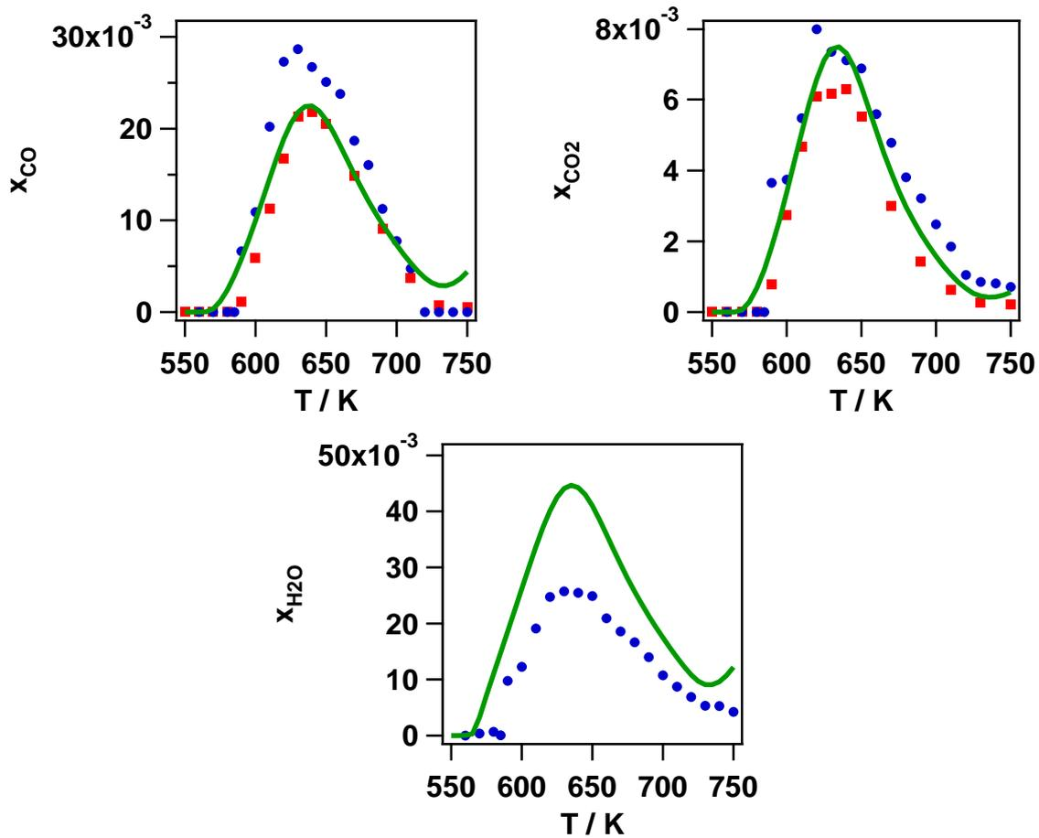
Figure IV-24 : CO, CO<sub>2</sub> et H<sub>2</sub>O dans le cas du *n*-butane (carrés = expériences réalisées à Nancy, ronds = expériences réalisées à Hefei, trait = simulation basée sur le mécanisme de type 3).
