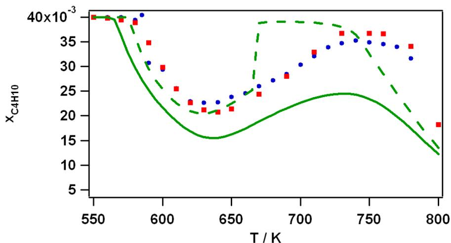
Figure IV-5 : Sensibilité de la réactivité par rapport à la cinétique des réactions d'oxydation des radicaux  $R\cdot$  et  $ROO\cdot$  à 3 et 4 atomes de carbone (trait continu = mécanisme de type 2, pointillés = modification des constantes de vitesse des réactions d'oxydation). Les constantes de vitesse ont été multipliées par un facteur 2.
