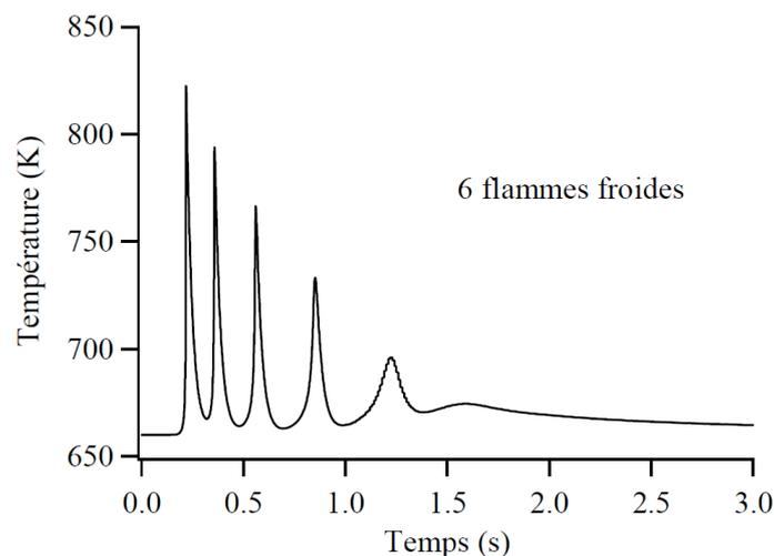
Figure I-2 : Résultat de simulation de la combustion en réacteur fermé d'un mélange *n*-butane/oxygène de richesse égale à 3,5 [Buda (2006)].
