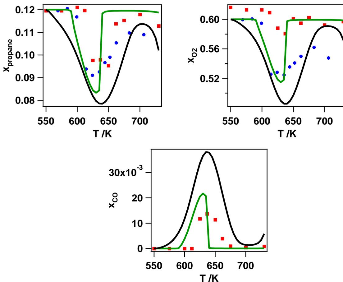
Tableau A4-1 : Profils expérimentaux (carrés = expériences réalisées à Nancy, ronds = expériences réalisées à Hefei) ou simulés (trait noir = mécanisme de type 1<sup>20</sup>, trait vert = mécanisme de type 3) du propane, de l'oxygène et de CO pour la combustion du propane à basse température.
