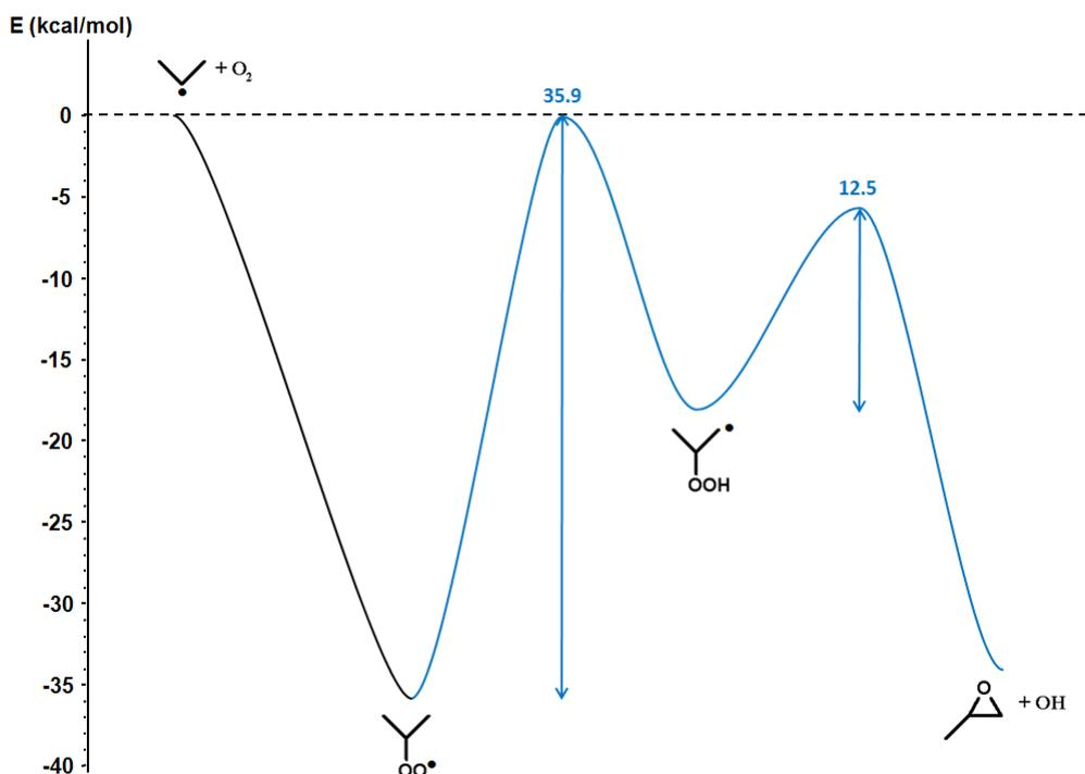
Figure III-3 : Diagramme d'énergie à 0 K des réactions d'isomérisation de radicaux ROO• et de formation d'éthers cycliques associées au système 2-C<sub>3</sub>H<sub>7</sub> + O<sub>2</sub>. Courbe bleu = isomérisation impliquant un état de transition comportant une partie cyclique à 5 atomes puis formation d'oxirane.
