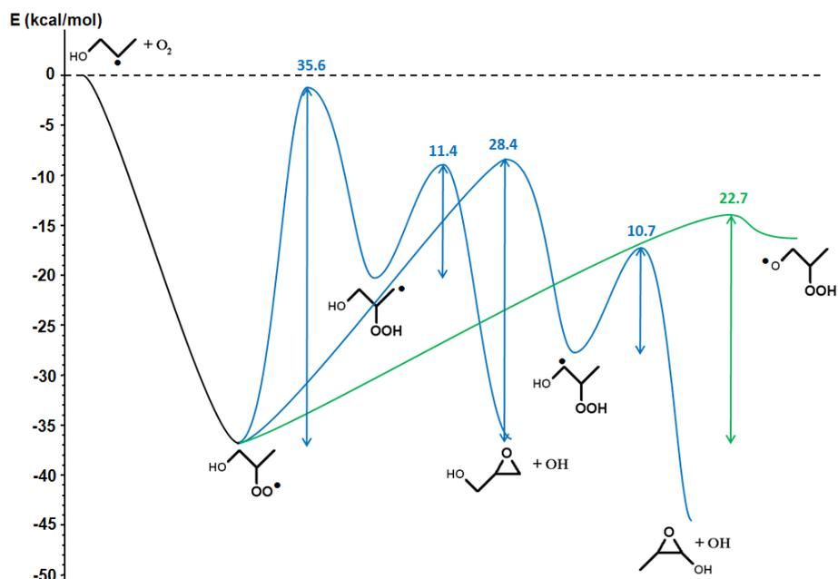
Figure III-19 : Diagramme d'énergie à 0 K des réactions d'isomérisation de radicaux  $R(OH)OO\bullet$  et de formation d'éthers cycliques associées aux réactions avec l'oxygène du radical 1-hydroxy-2-propyle. Courbes bleues = isomérisations impliquant un état de transition comportant une partie cyclique à 5 atomes puis formation d'hydroxy-oxiranes ; Courbe verte = réaction de Waddington.
