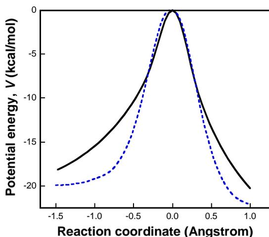
Figure II-7 : Energie potentielle le long de la coordonnée de réaction calculée (traits pleins) et ajustée à partir de la fonction paramétrée d'Eckart (traits pointillés) pour la réaction d'isomérisation du radical 1-heptyle faisant intervenir un état de transition comprenant un cycle à 5 atomes [Sirjean et al. (2012)].
