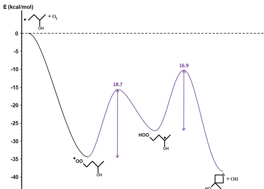
Figure III-24 : Diagramme d'énergie à 0 K des réactions d'isomérisation de radicaux  $R(OH)OO\bullet$  et de formation d'éthers cycliques associées au système 3-hydroxy-1-butyle +  $O_2$  ; Courbe violette = isomérisation impliquant un état de transition comportant une partie cyclique à 6 atomes puis formation d'hydroxy-oxétane.
