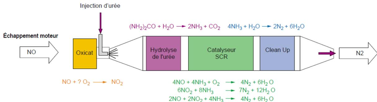
Figure 7 : Schéma d'un système SCR [IFP (2005b)].
