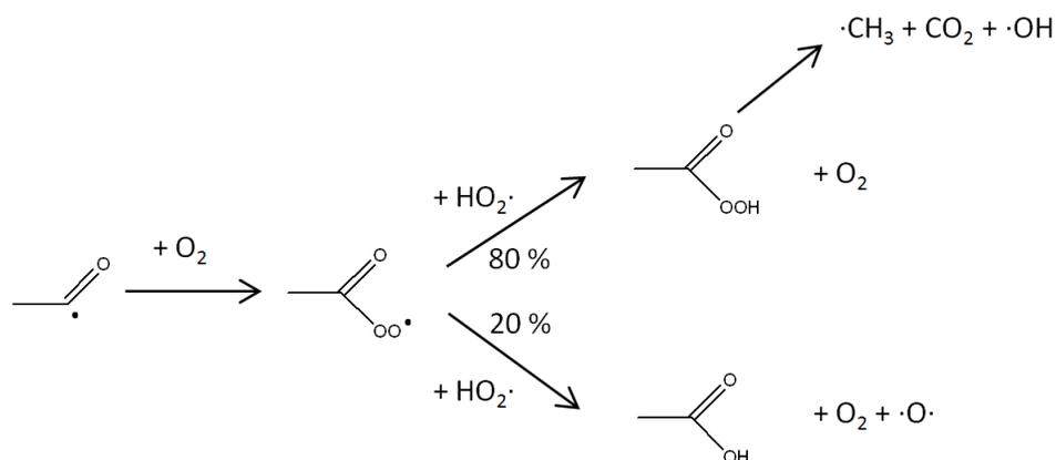
Figure IV-34 : Mécanisme de production d'acide acétique.
