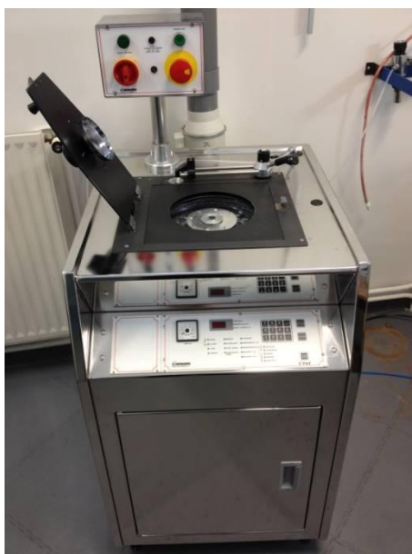
Figure 5-2 : Photographie de la tournette RC 5 STD (Karl Suss Technique S.A.) utilisée pour réaliser les dépôts en couches minces
