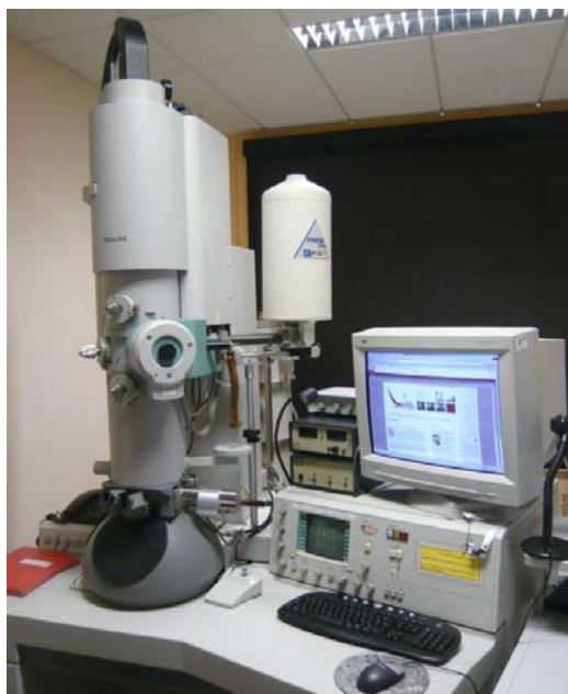
Figure 3-10 : Microscope électronique en transmission Philips FEI CM 200.
