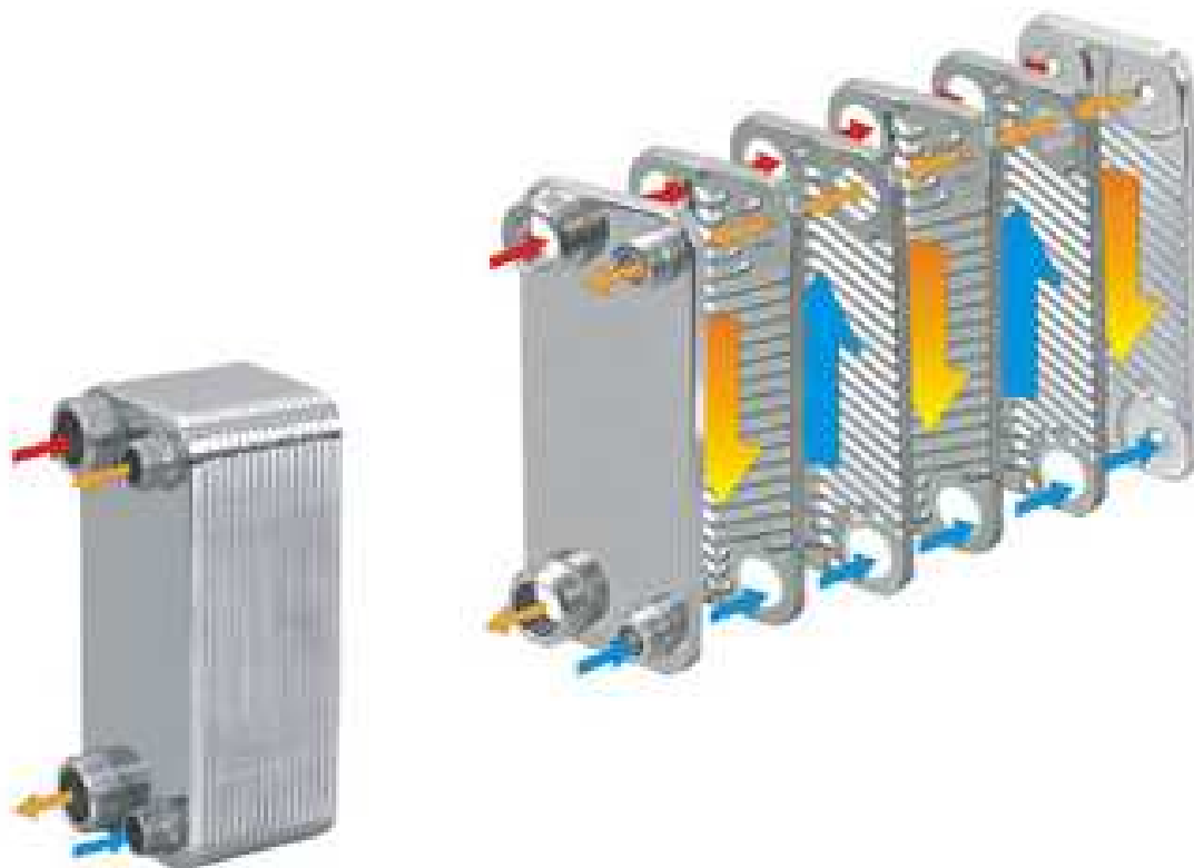
Fig. 4.3. Schimbător de căldură cu plăci [32]
