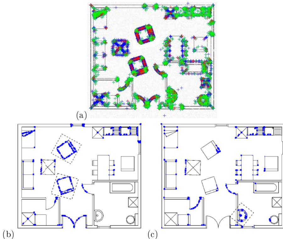
FIGURE 3.4 – Résultats de détection de quelques symboles dans un plan architectural. (a) Projection des points d'intérêt associés aux mots visuels d'un plan architectural, (b) Localisation d'un symbole requête de la Figure.3.3(b), (c) Localisation d'un symbole requête de la Figure.3.3(g).
