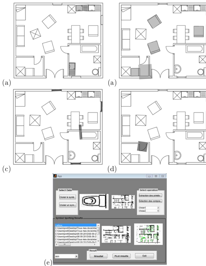
FIGURE 2.19 – Localisation de quelques symboles requêtes dans des documents graphiques : (a) interrogation de la requête de la Figure.2.14(i), (b) interrogation de la requête de la Figure.2.14(b), (c) interrogation de la requête de la Figure.2.14(g), (d) interrogation de la requête de la Figure.2.14(j) et (e) l'interface de "Symbol Spotting" mise en place.
