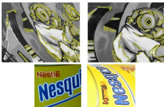
FIGURE 2.8 – Application du détecteur MSER sur quelques images ( http://www-master.ufr-info-p6.jussieu.fr/specialite/ima/bima/cours7.2p.pdf ).
