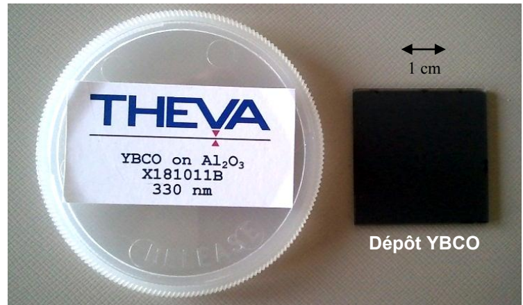
Figure 4.26. Caractéristiques du dépôt YBCO étudié
