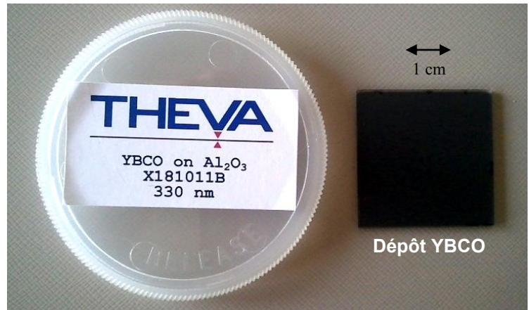
Figure 4.26. Caractéristiques du dépôt YBCO étudié
