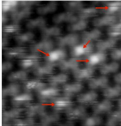
Figure 10 : Image STM expérimentale ( $10 \times 9,5 \text{ nm}^2$ ) enregistrées après le dosage de Pb à 0,38 MLE et 300 K sur le substrat (100)o-Al<sub>13</sub>Co<sub>4</sub> [17]. Les flèches rouges indiquent la position des atomes de plomb adsorbés sur la surface.
