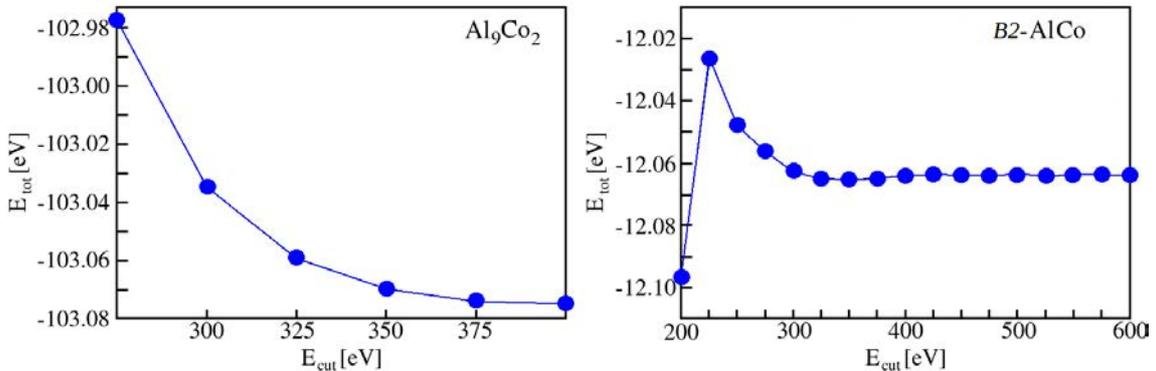
Figure 1 : Énergie totale  $E_{tot}$  vs énergie de coupure  $E_{cut}$  pour les systèmes massifs  $Al_9Co_2$  et  $B2-AlCo$  respectivement ( $smearing \sigma = 0,1 eV$ , points  $k$  : voir tableau 1).
