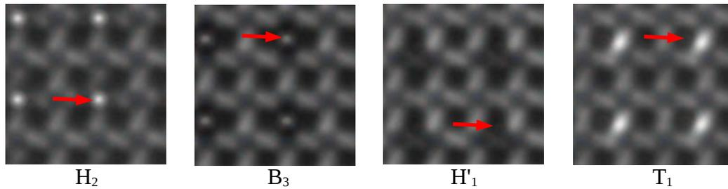
Figure 12 : Images STM simulées correspondant à l'adsorption d'oxygène dans les sites H<sub>2</sub>, B<sub>3</sub>, H'<sub>1</sub> et T<sub>1</sub>. La distance pointe-surface est de 4 Å et  $V_{bias} = -1,3$  V. La position de l'atome d'oxygène adsorbé est indiqué par la flèche.
