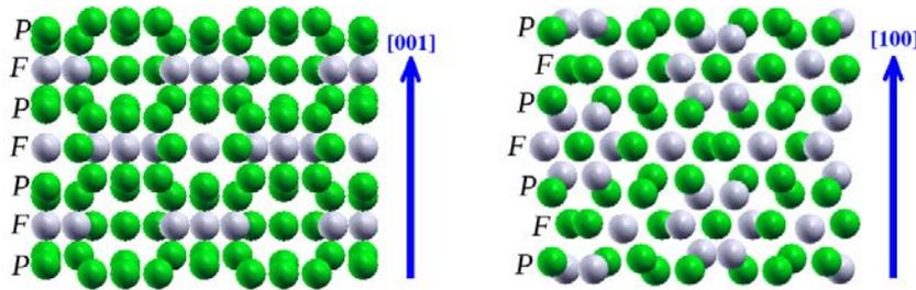
Figure 4 : Projection des plans atomiques du cristal Al<sub>5</sub>Co<sub>2</sub> selon les directions [001] et [100]. Les atomes d'aluminium sont représentés en vert et les atomes de cobalt en gris.
