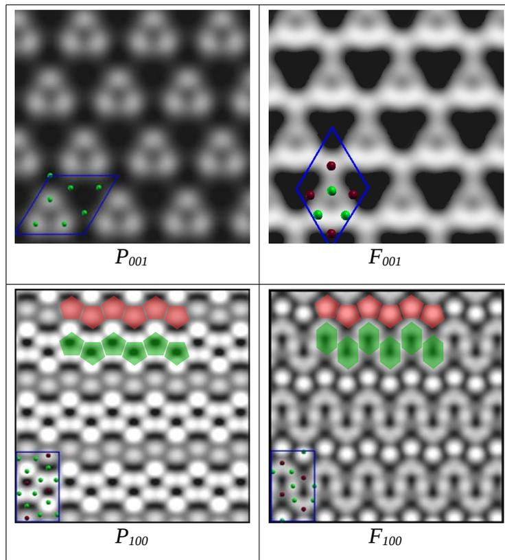
Figure 3 : Images STM simulées à partir de différents modèles de surface du cristal  $\text{Al}_5\text{Co}_2$ , en utilisant  $h = 3 \text{ \AA}$  et  $V_{PS} = 0,7 \text{ V}$ . Une maille élémentaire de surface est superposée : les sphères rouges correspondent aux atomes de cobalt et les sphères vertes représentent les atomes d'aluminium.
