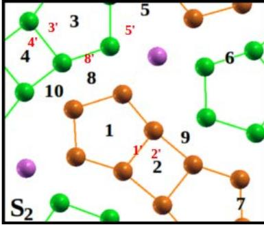
Figure 15 : Modèle de surface et sites d'adsorption envisagés sur la surface (100)-Al<sub>13</sub>Co<sub>4</sub> (surface 1x1). Les sphères vertes, oranges et roses correspondent aux atomes d'aluminium de surface. Les sphères roses représentent les atomes d'aluminium « glue » entre les bipentagones.
