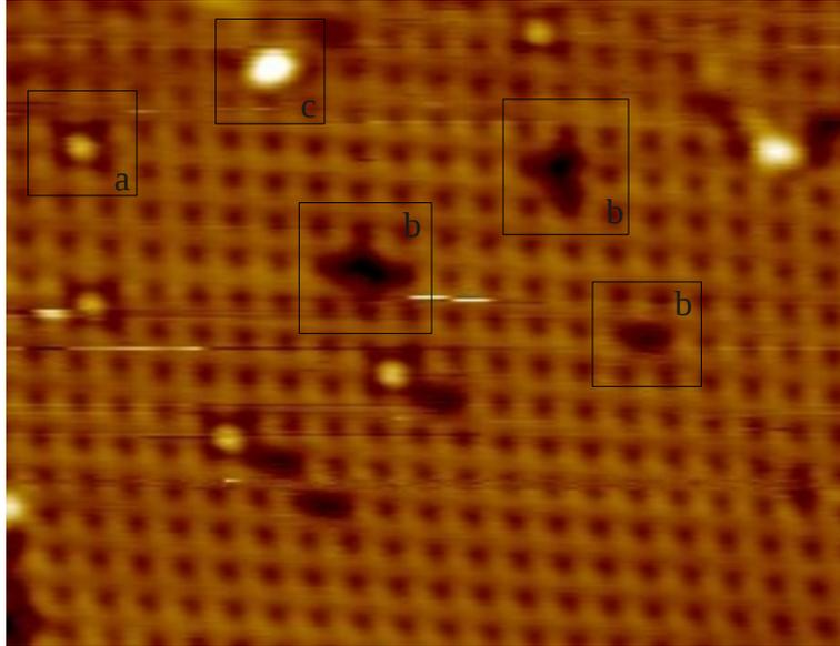
Figure 10 : Image STM expérimentale enregistrée à 300K et pour un taux de couverture égal à 0,5 MLE (9,58x12,13 nm<sup>2</sup>, V<sub>bias</sub> = -2 V). Différents types de motifs observés dans les STM sont entourés par un cadre noir.
