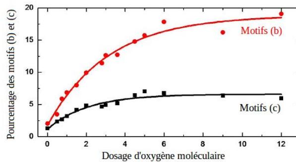
Figure 11 : Pourcentage de motifs de type (b) et (c) après dosage de O<sub>2</sub> (en nm<sup>2</sup>/nm<sup>2</sup>).
