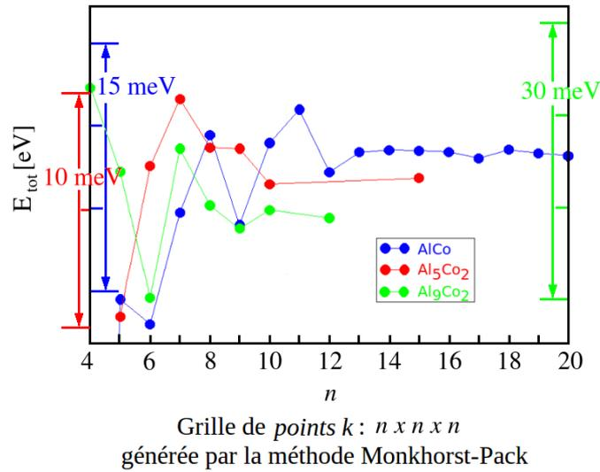
Figure 2 : Énergie totale  $E_{tot}$  vs grille de points  $k$  pour les systèmes massifs  $B2\text{-AlCo}$  ( $\text{smearing } \sigma = 0,1 \text{ eV}$ ,  $E_{cut} = 450 \text{ eV}$ ),  $\text{Al}_5\text{Co}_2$  et  $\text{Al}_9\text{Co}_2$  ( $\sigma = 0,1 \text{ eV}$ ,  $E_{cut} = 350 \text{ eV}$ ).
