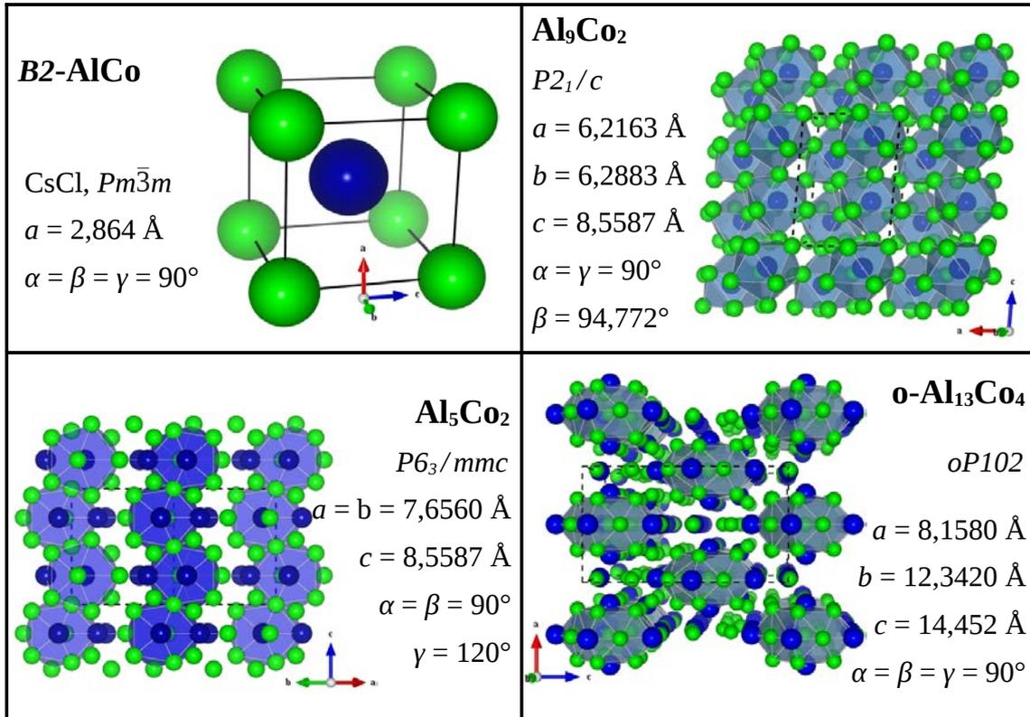
Figure 6 : Données cristallographiques des composés intermétalliques B2-AlCo [40], Al<sub>9</sub>Co<sub>2</sub> [41], Al<sub>5</sub>Co<sub>2</sub> [42] et o-Al<sub>13</sub>Co<sub>4</sub> [9]. La structure en cluster caractéristique, ainsi que la maille élémentaire (lignes pointillées) sont présentées pour chaque structure [45]. Les sphères vertes représentent les atomes d'aluminium et les sphères bleues, les atomes de cobalt.
