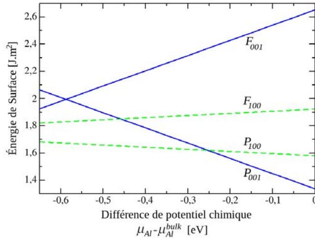
Figure 5 : Énergies de surface des différentes terminaisons de surface pour chaque orientation considérée. Le potentiel chimique  $\mu_{Al}$  correspondant à l'aluminium fcc est pris comme référence ( $\mu_{Al}^{bulk} = -3,74 \text{ eV}$ ).
