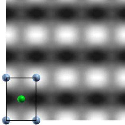
Figure 2 : Image STM calculée pour la surface (110)B2-AlCo ( $h = 3 \text{ \AA}$  et  $V_{PS} = 0,7 \text{ V}$ ). Une maille élémentaire de surface est superposée : les sphères grises correspondent aux atomes de Co et la sphère verte représente l'atome d'aluminium.
