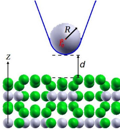
Figure 1 : Représentation schématique de la pointe du microscope à effet tunnel proche de la surface d'un échantillon. La pointe de géométrie sphérique (rayon  $R$ ), est à la position  $\vec{r}_0$ , à une distance  $d$  de la surface.
