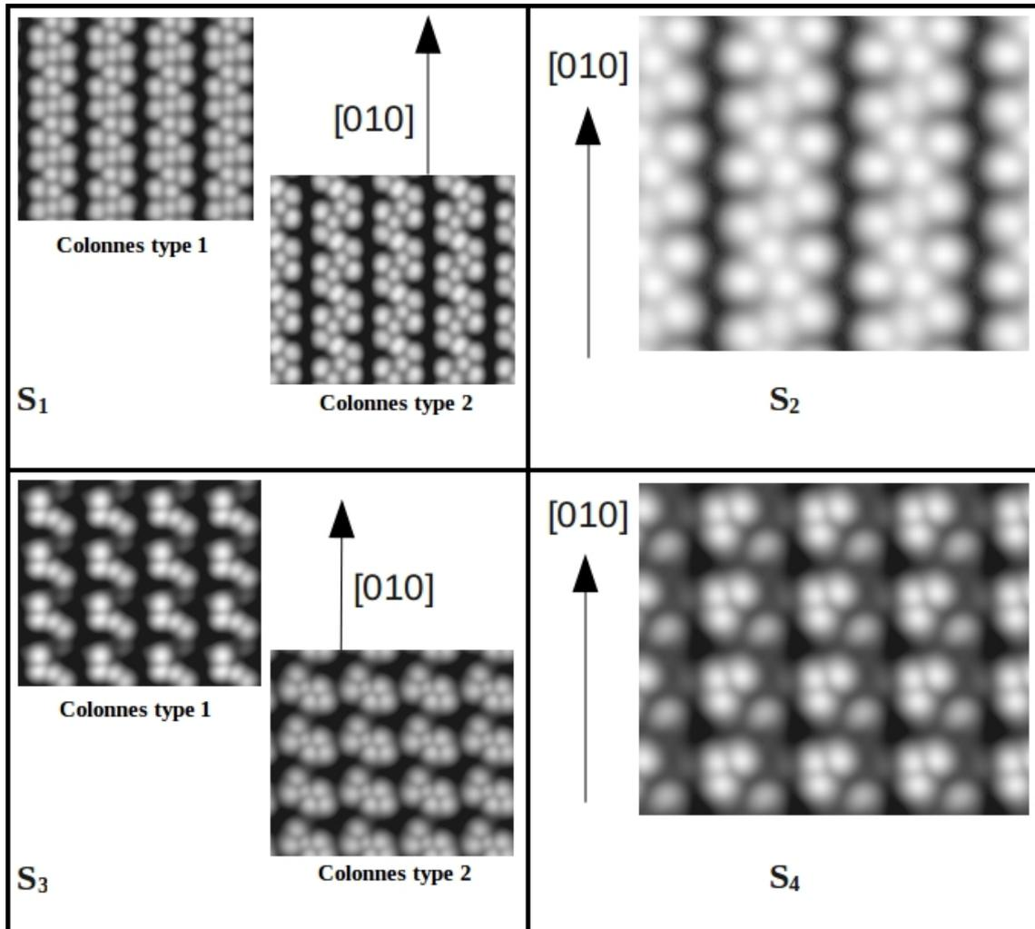
Figure 9 : Images STM simulées (obtenues à une distance de 4 Å et  $V_{bias} = -0,7 eV$  – maille élémentaire 4x4) du dépôt de Pb (0,4 MLE) formant des structures en forme de colonnes selon la direction [010] sur les surface des modèles S<sub>1</sub>, S<sub>2</sub>, S<sub>3</sub> et S<sub>4</sub>. Pour les modèles S<sub>1</sub> et S<sub>3</sub> nous présentons les deux types de colonnes construites (voir texte).
