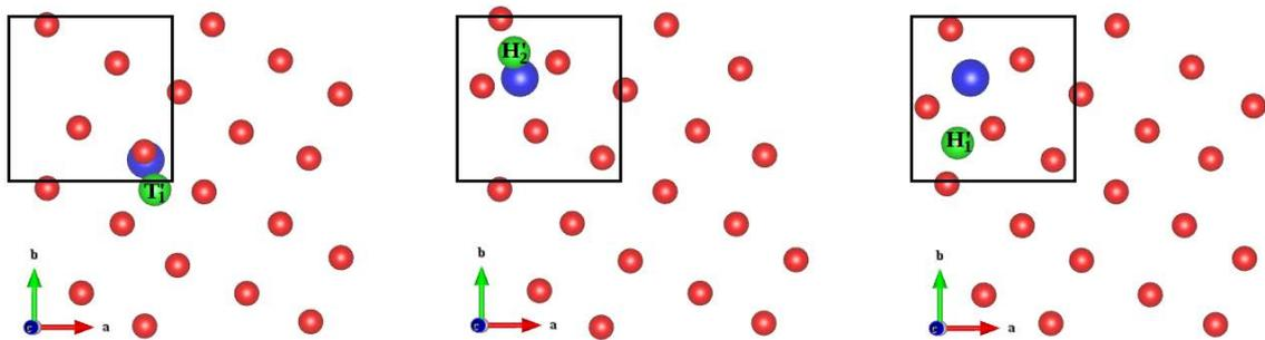
Figure 5 : Relaxation après l'adsorption d'oxygène sur la surface (001)Al<sub>9</sub>Co<sub>2</sub> (maille élémentaire de surface 1x1 en ligne noire), formant un site de symétrie 3 dans les sites T<sub>1</sub>, H'<sub>2</sub> et H'<sub>1</sub>. Les sphères rouges correspondent aux atomes d'aluminium d'extrême surface. La sphère bleue indique la position de l'atome de Co le plus proche de l'atome d'oxygène adsorbé (sphère verte).
