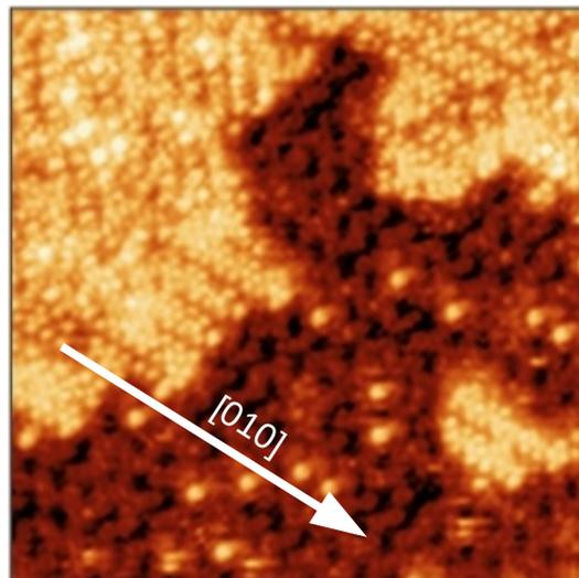
Figure 8 : Image STM expérimentale de haute résolution (20x20 nm<sup>2</sup>) montrant la structure de surface après le dépôt de 0,38 MLE de Pb à 300 K sur le substrat (100)o-Al<sub>13</sub>Co<sub>4</sub>.
