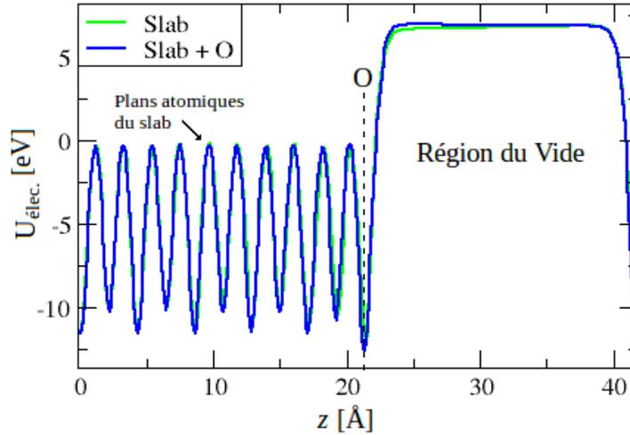
Figure 4 : Énergie potentielle électrostatique moyenne selon l'axe  $z$  d'une supercellule contenant (i) des slabs séparées par une région de vide de 20 Å et (ii) des slabs séparées par une région de vide de 20 Å plus un atome d'oxygène.
