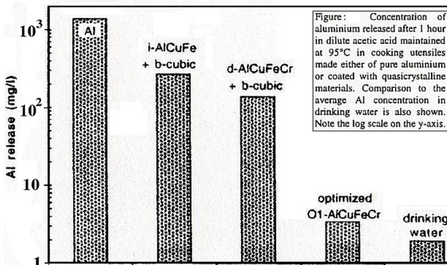
Figure 3 : Propriétés de corrosion des CMA dans un milieu acide en comparaison de l'aluminium pur (mesurées par la perte d'aluminium en  $mg/l$ ) [22]. La teneur d'aluminium dans l'eau de robinet est aussi présentée.
