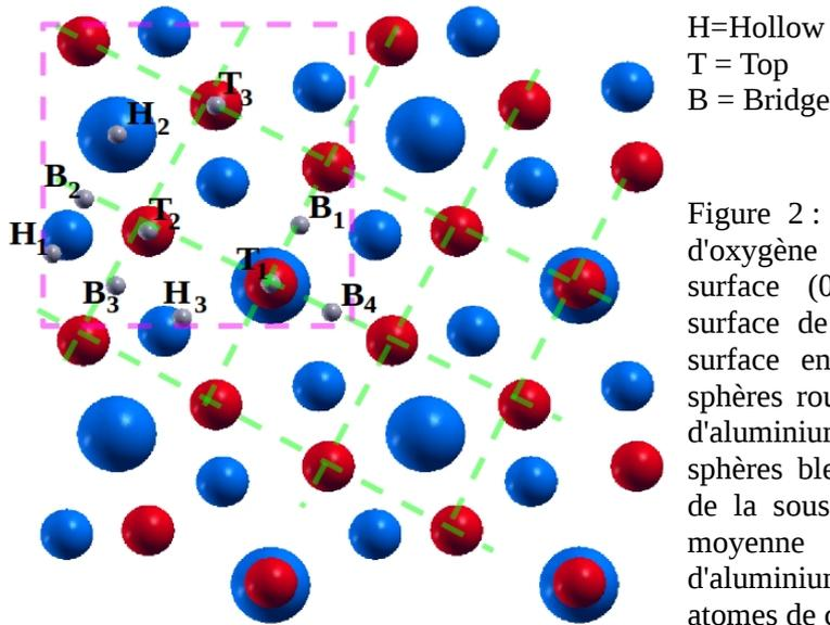
Figure 2 : Sites d'adsorption des atomes d'oxygène (petites sphères grises) sur la surface (001)Al<sub>9</sub>Co<sub>2</sub> (cellule unité de surface de 2x2 – maille élémentaire de surface en ligne pointillée rouge). Les sphères rouges correspondent aux atomes d'aluminium d'extrême surface. Les sphères bleues correspondent aux atomes de la sous-surface : les sphères de taille moyenne correspondent aux atomes d'aluminium et les grandes sphères aux atomes de cobalt.
