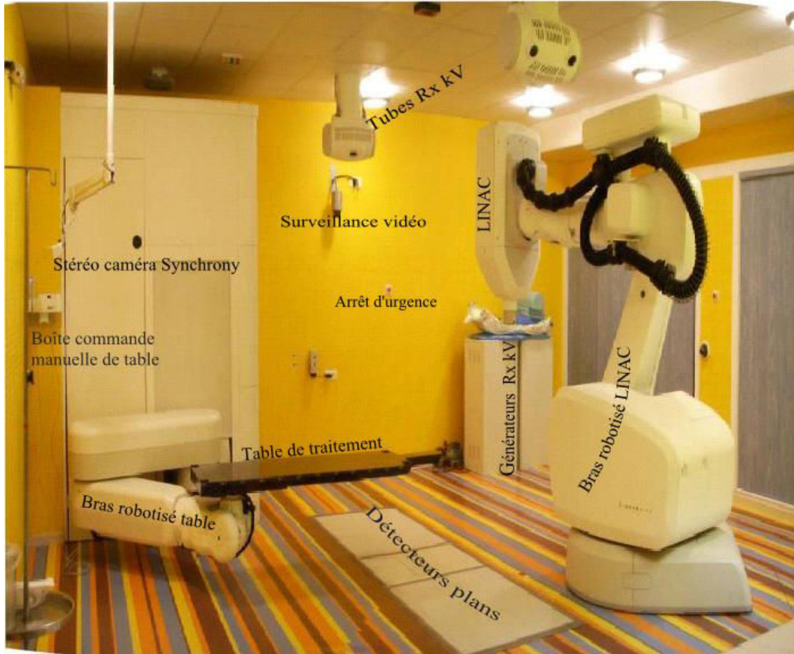
Figure 20. Vue d'ensemble de la salle de traitement par le CyberKnife™
