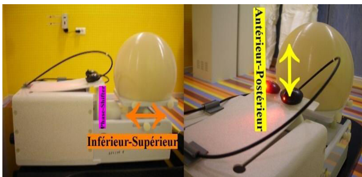
Figure 57. Plateforme ACCURAY de simulation de mouvement pour le contrôle de qualité pour le suivi respiratoire par Synchrony™
