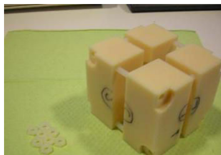
Figure 46. Ball-cube : objet-test utilisé pour la réalisation du test E2E
