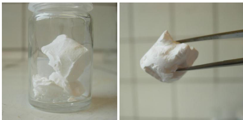
Figure 102 : photos d'un aérogel élaboré à partir d'un organogel du gélateur 1 à 1% en masse dans le toluène.
