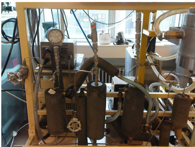
Figure 96 : ligne d'alimentation en CO 2 .
